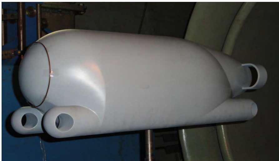
Рис. 6. Модель ПА, установленная в аэродинамической трубе СПБГМТУ
