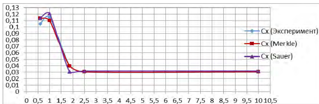
Рис. 1. Коэффициент сопротивления в зависимости от числа кавитации
