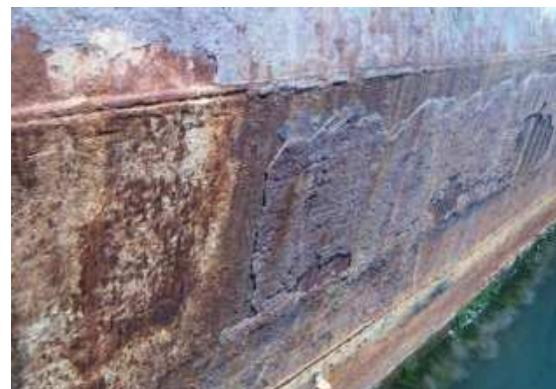
Рис.1. Коррозионное разрушение бортовой обшивки научно-исследовательского судна «Григорий Максимов»
