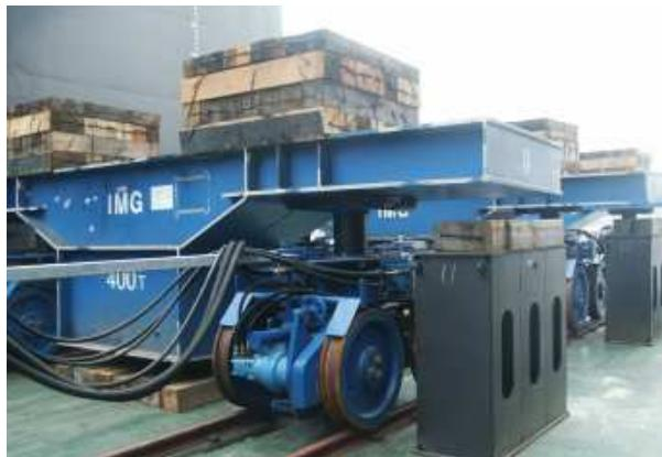
Рис. 8. Кормовая опора с гидравлической тележкой
