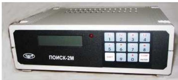
Рис. 5. Преобразователь виброизмерительный «ПОИСК – 2М»
