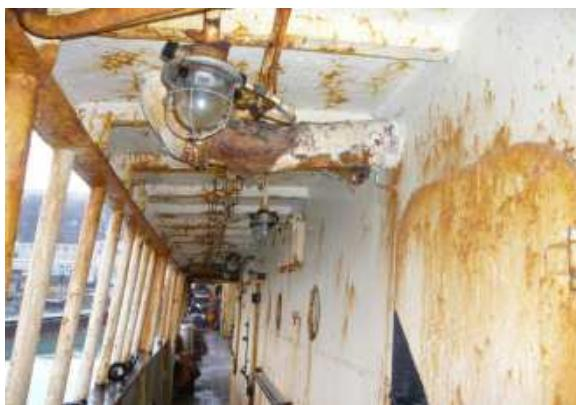
*Рис. 4. Коррозия конструкций рубки РТМС «Курилы». В возраст судна 28 лет. Судно прошло ремонт и докование в 2005 г. (фото 2006 г.)*
