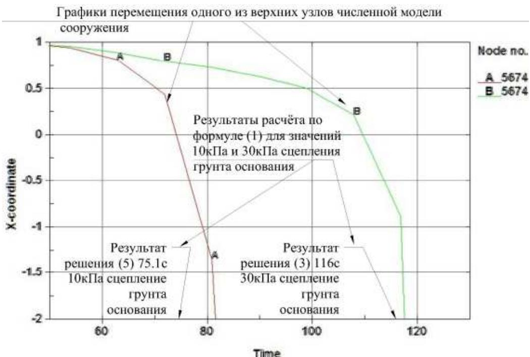
Рис. 5. Графики перемещения верхней части сооружения в направлении оси X и теоретические решения по формуле (1) для 10 и 30 кПа
