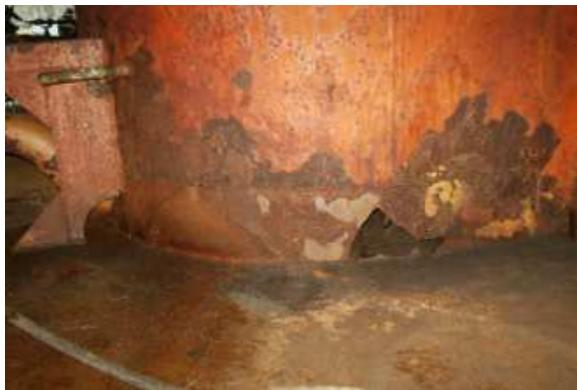
Рис. 3. Повреждение колонки вследствие утонения стенки в результате коррозии на верхней палубе танкера «Владимир Колечицкий»
