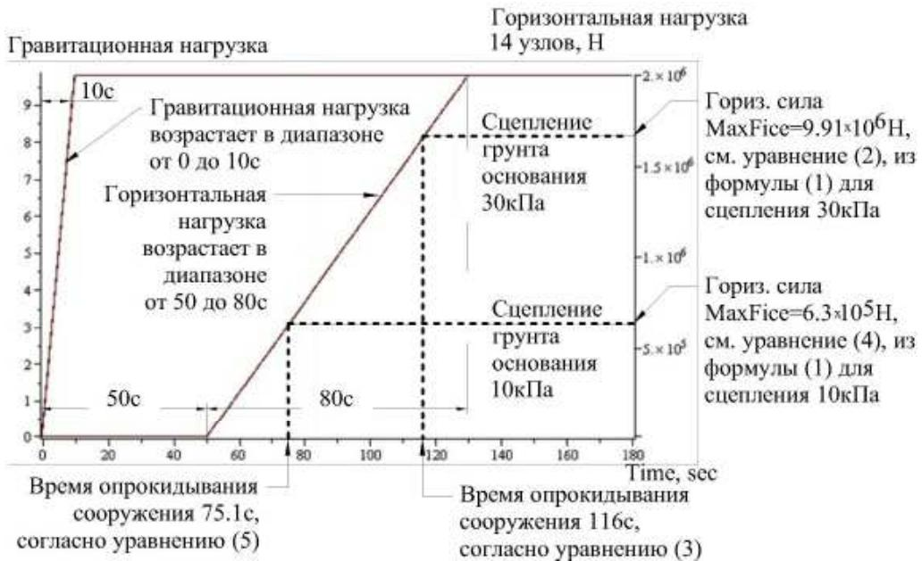
Рис. 3. Зависимость гравитационной нагрузки (левая ось) и горизонтальной силы (правая ось) от времени
