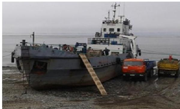
Рис.5 Процедура грузовых операций в состоянии осушения судна
