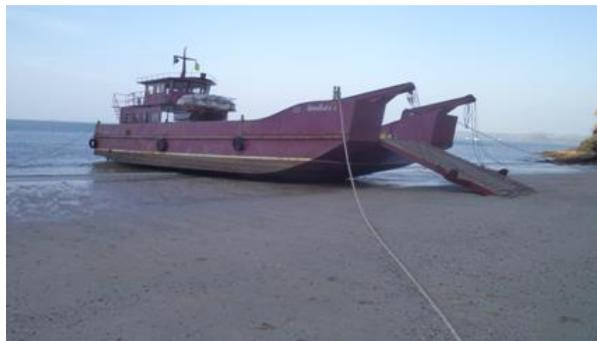
Рис.7 Специальное судно для грузовых операций с осушением (Тайланд)
