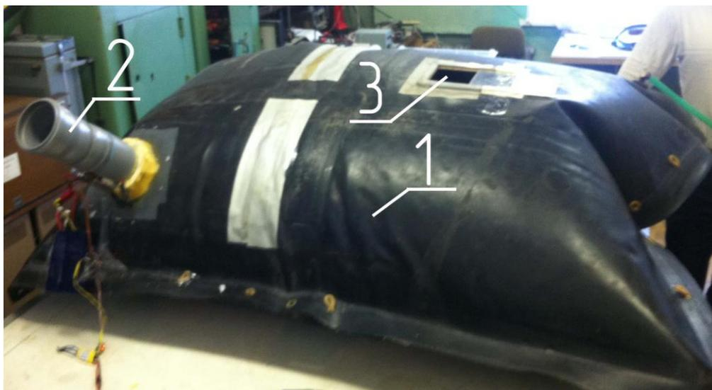
Рис. 2. Фотография установки для экспериментального определения площади истечения: 1- эластичная емкость; 2-нагнетатель; 3-регулируемая заслонка
