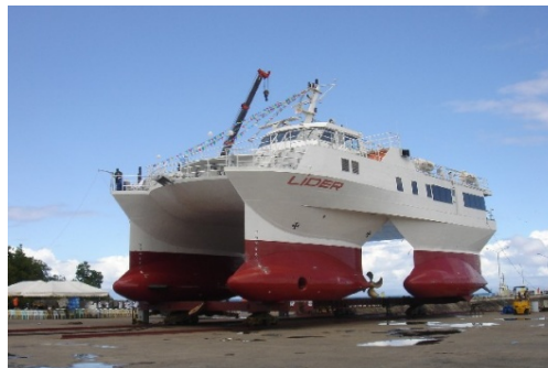
Рис.5. Скоростное судно Lider – квадримаран для перевозки обслуживающего персонала нефтедобывающих платформ
