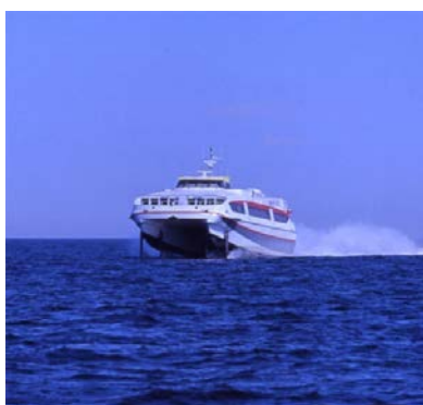
Рис.3. Катамаран с носовым подводным крылом между корпусами
