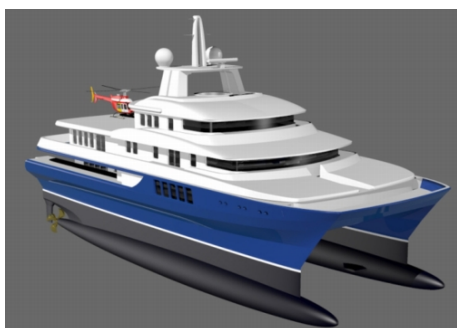
Рис.2. Катамаран с малой площадью ватерлинии и гондолами вблизи основной плоскости
