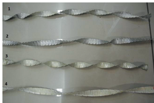
Рис. 1. Интенсификаторы типа "гофрированная лента с надрезами": 1, 2, 3, 4 - номера образцов с конструктивными характеристиками из табл. 1.
