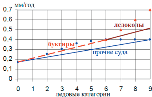
Рис. 6. Предлагаемая схема гармонизации среднегодовых уменьшений толщин (для носового района усиления в поясе ватерлиний)
