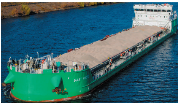
Рис.12. Перевозка навалочного груза на комбинированном судне проекта RST54
