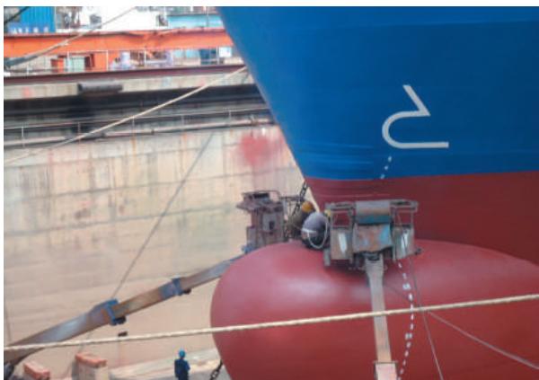
Рис. 5. Завершение ремонта над бульбом
