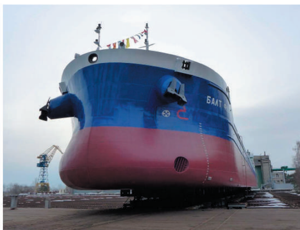
Рис. 3. Носовая оконечность «сверхполного» судна
