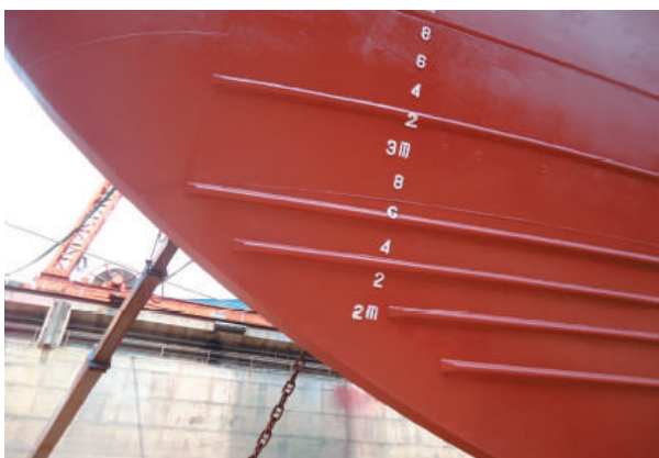
Рис. 6. Завершение усиления бульба
