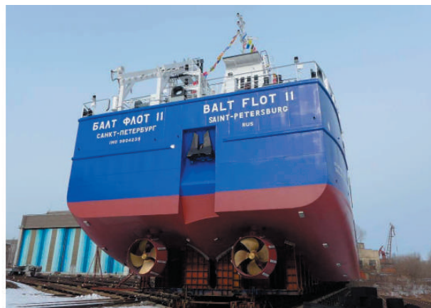
Рис. 4. Кормовая оконечность «сверхполного» судна
