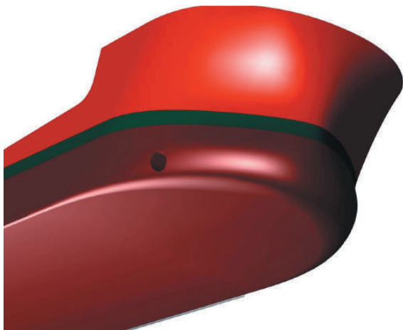
Рис. 3. Носовая оконечность «сверхполного» судна
