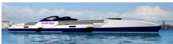
Рис 22. Скоростной пентамаран L=290 м, B= 45 м D =6500 т, U = 41,5 узла.
