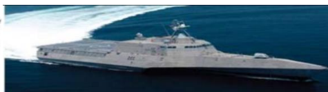
Рис. 21. Тримаран L=127 м, B=31,6 м, U = 40 узл, D = 210 т. 4 водомёта
