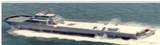
Рис. 14. Судно SES-200. L=48,8 м, В=13,1м, D=150т. до 205т, U = 25 узл.
