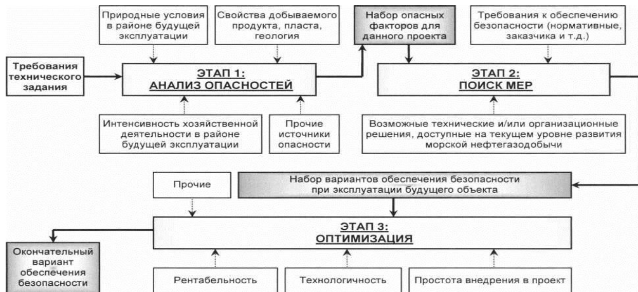
Рис. 1. Укрупненная модель обеспечения безопасности МНГК
