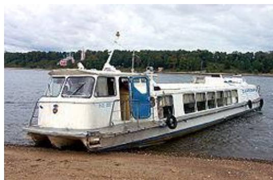
Рис. 3. Водомётный теплоход «Заря». Главные размерения: длина – 22,4 м, ширина – 4,6 м., осадка неподвижного – 0,5 м.осадка на ходу – 0,4 м. мощность двигателя – 900 л.с.
