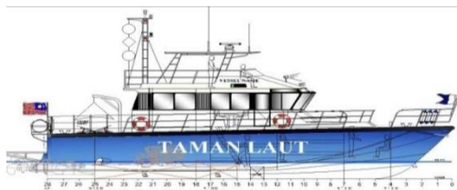
Рис. 20. Спортивное судно L = 20,11 м, B = 5,2 м, D = 35 т два двигателя и два водомёта, U = 28 узл
