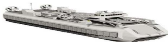
Рис. 16. Катамаран T-Craft L= 80,7 м, В= 20,6 м с корпусами В= 5м, D=1792 т, U = 30 узл..
