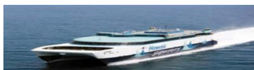
Рис. 18.. Большое красивое судно L=106,5м, В= 23,8 м, D = 800т, U = 40 узл, 4 водомёта КаМеВа 125 S11, 4 главных двигателя.
