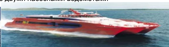
Рис. 19. Высокоскоростной пассажирский катамаран L= 52,4 м, В=13м, U = 40 узл, 4 двигателя, 4 водомёта КаМеВа S11
