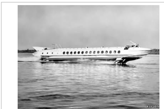
Рис. 4. Скеговое судно на воздушной подушке типа «Чайка»
