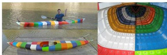
Рис. 5. Напечатанная байдарка. Испытания и вид изнутри [20].
