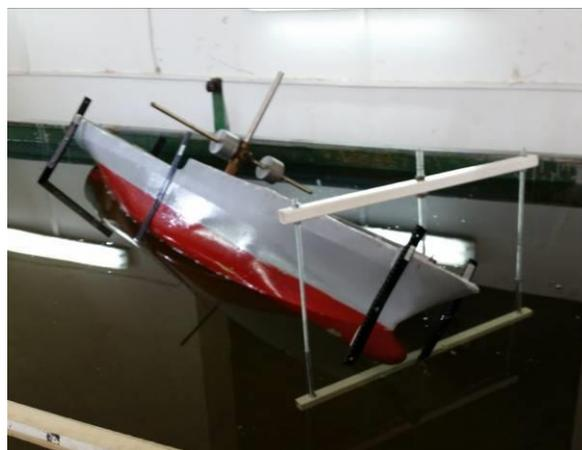
Рис. 6. Вид со стороны носовой оконечности на модель судна в процессе испытаний
