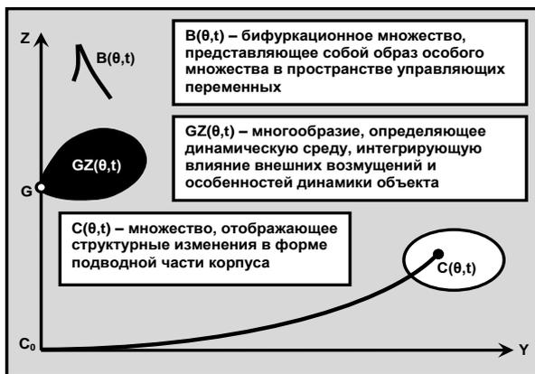
Рис. 2. Динамическая модель катастрофы, отображающая область моделирования поведения судна на волнении
