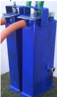
Рис.7. Блок гидравлических затворов
