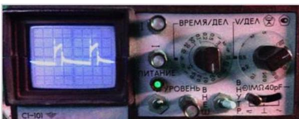
Рис. 10. Осциллограмма тока питания электролизера
