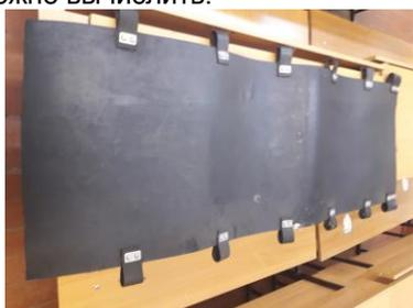
Рис. 1. Гидродинамический щиток из полиуретановой ленты
