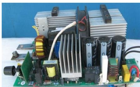
Рис. 4. Плата инверторного источника
