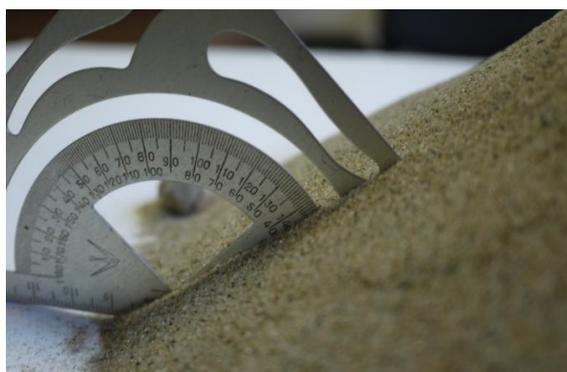
Рис. 1 Определение угла естественного откоса
