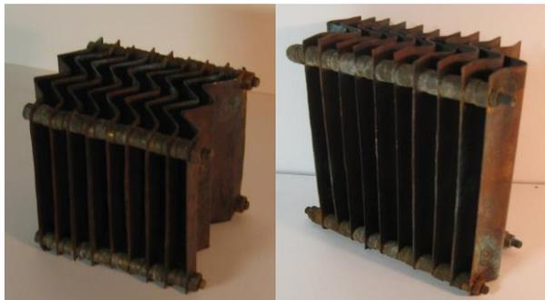
Рис.1. Исследуемые вертикальные жалюзийные сепараторы № 1 и № 2
