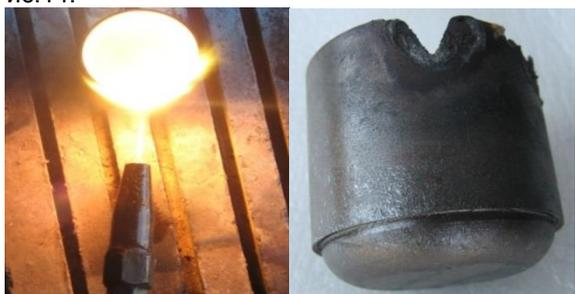
Рис. 14. Нагрев образца и его расплавление
