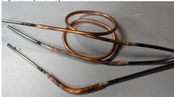
Рис.16 Образцы паянных трубок
