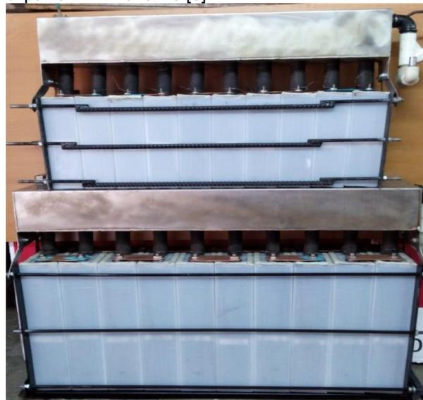
Рис. 13 ЭВГ производительностью 600 и 900л газовой смеси в час
