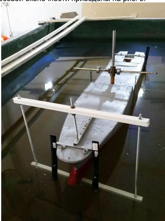
Рис. 4. Модель судна в процессе испытаний
