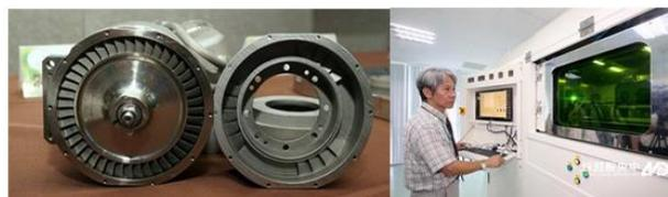
Рис. 6. Примеры напечатанных металлических деталей (слева) и 3D-принтер для их печати (справа). Фото с [22]
