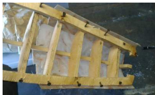
Рис. 6. Изготовление шаблонов по теоретическому чертежу
