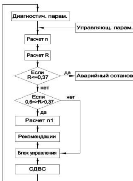
Рис. 6. Упрощенный алгоритм управления СДВС с учетом функции диагностики технического состояния
