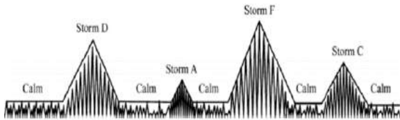
Рис.1. Модель последовательности нагрузок [18]
