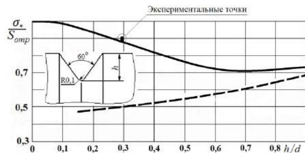
Рис. 6. Сопоставление результатов конечно-элементного расчета напряжений при разрыве образцов с надрезом \sigma_* , найденных при использовании интегрального критерия (3) (сплошная линия) и локального критерия (1) (штриховая линия), с экспериментальными данными (четыре точки).
