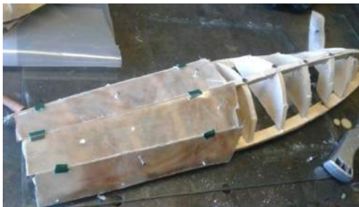
Рис. 7. Разделка корпуса на ленты
