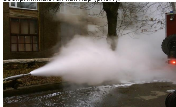
Рисунок 1 – Струя ВСМФС после взрывного вскипания и образование облака водной среды
