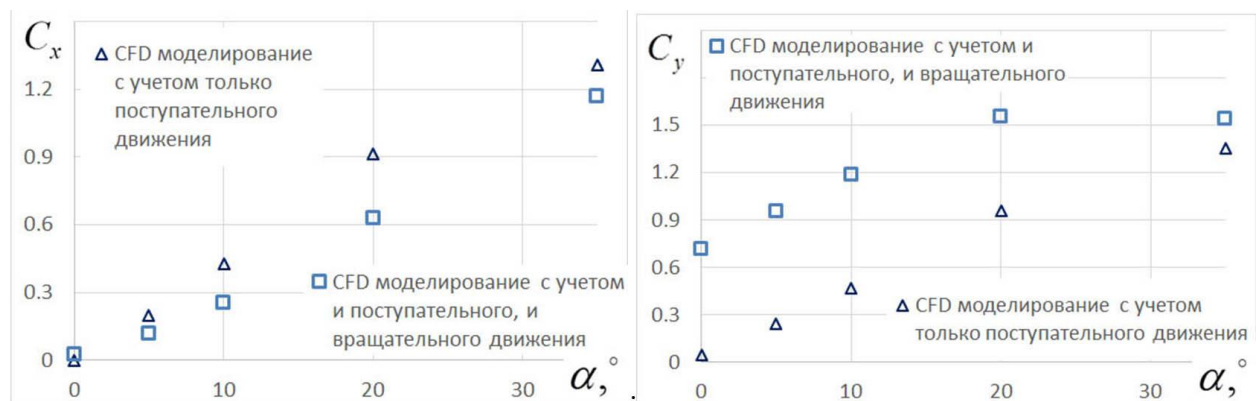
Рисунок 5 – Результаты CFD-моделирования обтекания рулей струей движителя с учетом и без учета вращения
