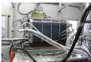
Рис. 3 Опытный образец батареи топливных элементов мощностью 50 кВт
