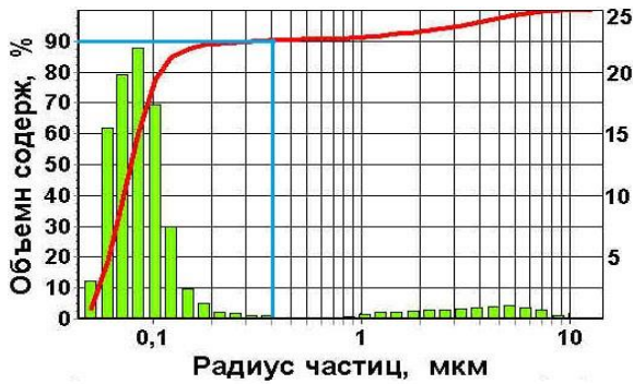
Рисунок 2 - Гистограмма и интегральная кривая объёмного (массового) распределения (содержания) капель сконденсированного пара и воды по размерам для сопла Лавала при температуре недогретой воды перед соплом 170° С.
