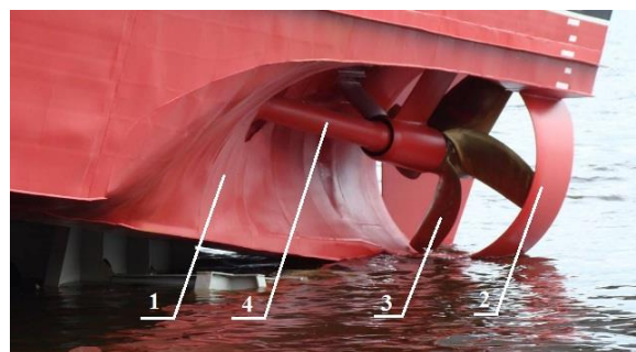
Рисунок 1 – Движитель СВК: 1 – водозаборник, 2 – кольцевая насадка винта, 3 – гребной винт, 4 – гребной вал
