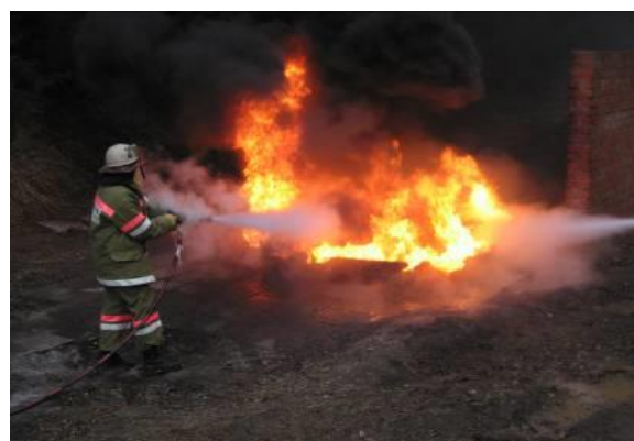
Рисунок 6 – Поверхностное тушение струями ВСМФС
