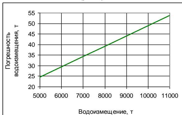
Рис.7. Погрешность водоизмещения, вызванная погрешностью ареометра
