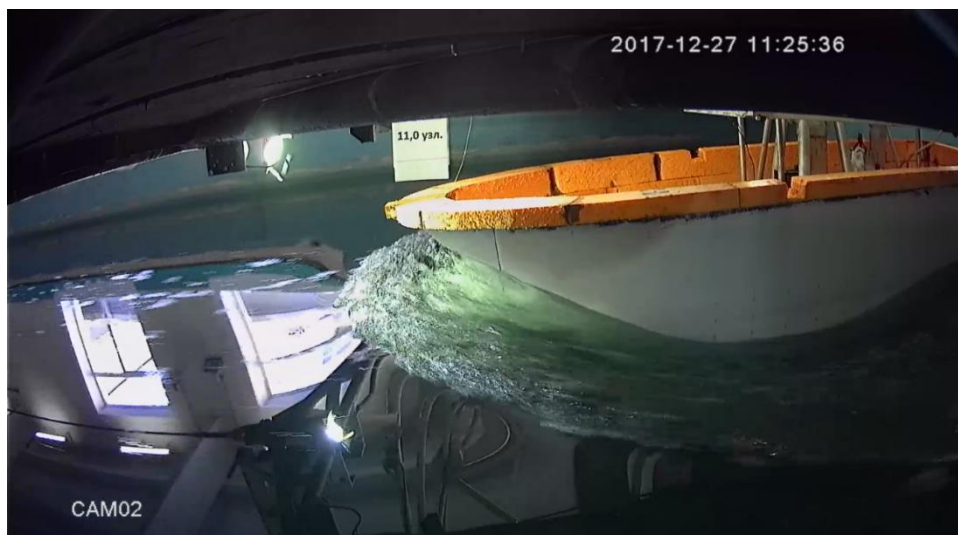
Рис. 8. Вид сбоку (форштевень) в 1 случае нагрузки. Скорость 11 узлов.
