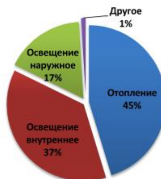
Рис. 5. Структура нагрузок в сети с номинальным напряжением 220 В
