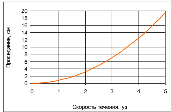
Рис.5. Проседание судна на течении
