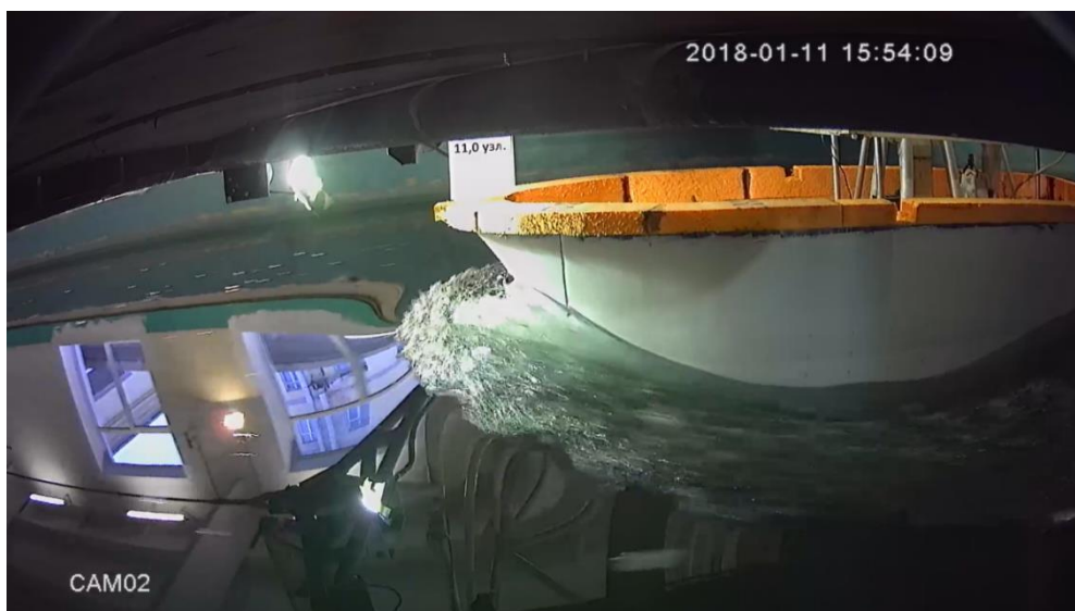
Рис. 9. Вид сбоку (форштевень) во 2 случае нагрузки. Скорость 11 узлов.
