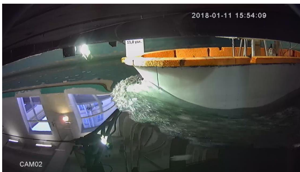
Рис. 10. Вид сбоку (форштевень) в 3 случае нагрузки. Скорость 11 узлов.
