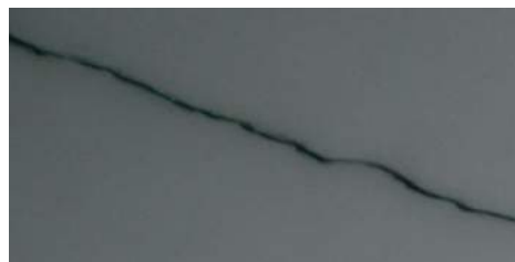
Рис. 4. Трещина в моделированном ледовом поле
