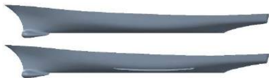
Рис. 1. Модель DTMB 5415: сверху – голый корпус, снизу – корпус со скуловыми килями
