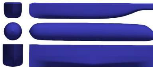
Рис. 2. Трехмерные модели исследуемых корпусов: сверху – классические корабельные обводы, посередине – торпедообразные обводы, снизу – упрощенные обводы
