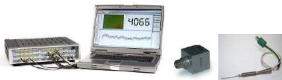
Рис. 2. Мобильная система сбора и предварительной обработки экспериментальных данных LMS SCADAS: основной корпус мобильной системы; протативный компьютер; акселерометр PCB 333в32 и соединительный кабель
