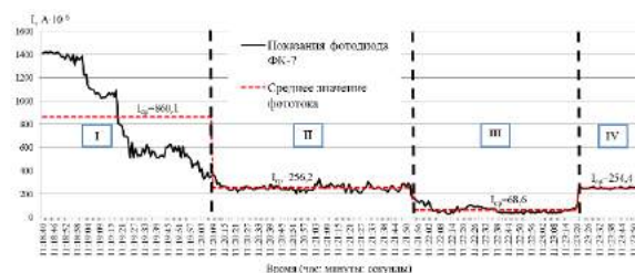
Рисунок 8 – График изменение фототока в процессе работы УОА (с параметрами воды P=2 МПа; T=180 °С) и осаждения продуктов горения от дымовой шашки РДГ-24
