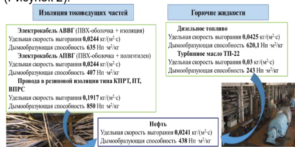
Рисунок 2 – Пожароопасные свойства характерной горючей нагрузки для объектов, связанных с превращением одного вида энергии в другую
