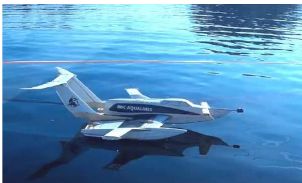
Рис. 1. Буксируемая модель экраноплана ООО «RDC Aqualines» на испытаниях
