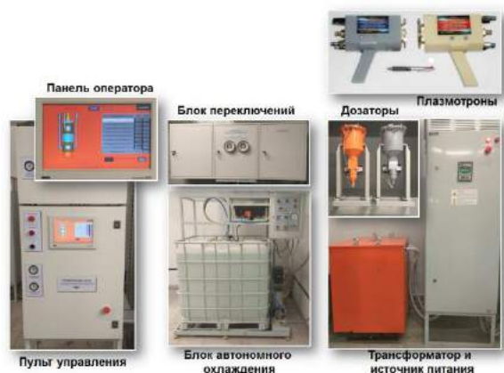
Рис. 4. Установка плазменного напыления порошковых материалов «Термоплазма 50-03»
