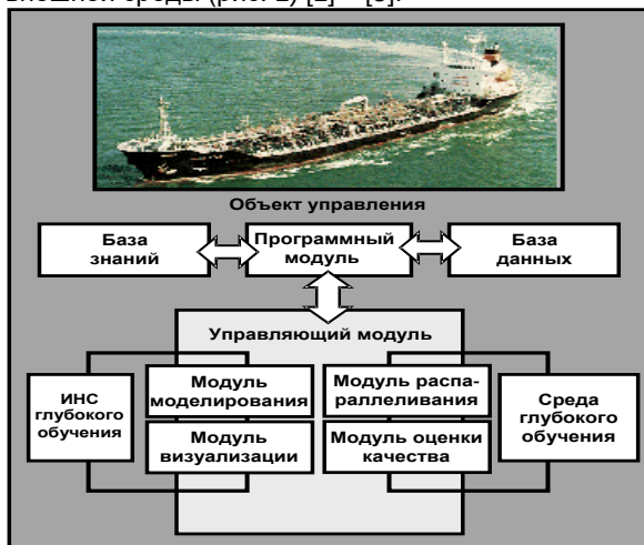
Рис. 1. Поток информации при контроле маневрирования судна АЛП в нестационарной среде
