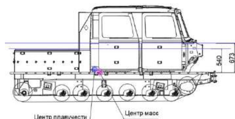
Рис. 6. Погруженность первого звена машины на ровный киль
