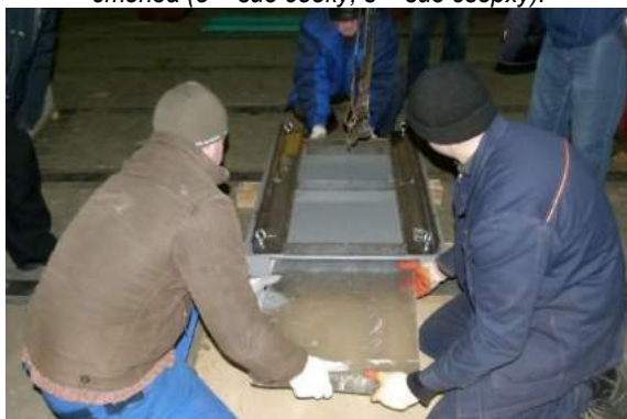
Рис. 3. Установка блока льда в направляющий контейнер
