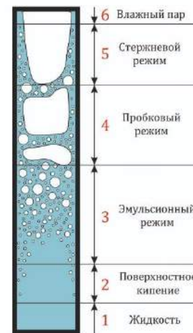
Рис.2. Структура двухфазного потока при кипении жидкости внутри вертикальной трубы:
