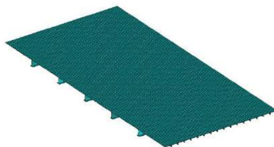
Рис. 4. Балочно-пластинчатая модель перекрытия
