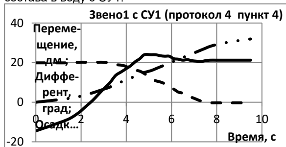
Рис.4. Параметры движения звена 1 при динамическом спуске гусеничного состава в воду
