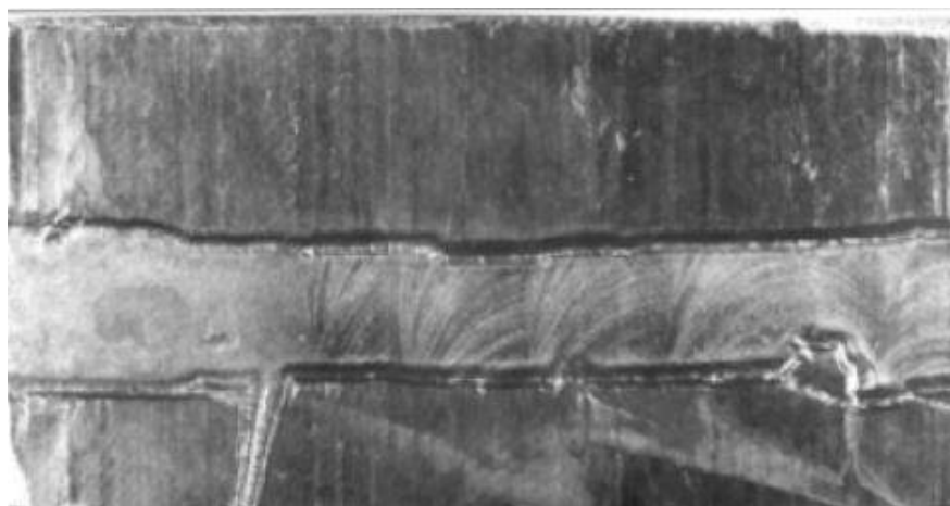
Рис.3. Фотография протравленной поверхности металла, подвергнутой УУО обработке (левая часть – литой металл, правая часть - наплавленный металл)
