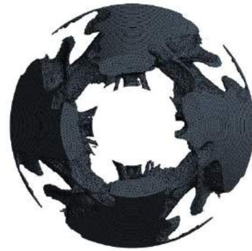
Рис. 6 Результат топологической оптимизации полости ступицы винта при ограничении на массу подкреплений ( \alpha = 0,6 ): а) вид в изометрии; б) вид сверху
