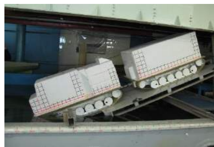
Рис.3. Схема экспериментального стенда: 1 - первое звено гусеничного состава; 2 – второе звено; 3 – сцепное устройство; 4 – транспортирующая тележка (салазки); 5 – направляющие рельсы; 6 – механизм изменения угла наклона « \alpha »; 7 – зубчатая лебедка с ручным приводом; 8 – направляющий шкив; 9 – буксирный трос; 10 – буксировочная тележка с электромеханическим приводом
