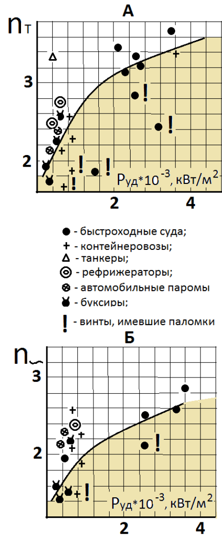
Рис. 3. Кривые минимально допустимых значений коэффициентов запаса статической «А» и циклической «Б» прочности гребного винта
