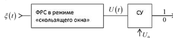
Рис. 1 – Структура обнаружителя: ФРС – формирователь решающей статистики, в режиме «скользящего окна»; СУ – селектор сигнала по уровню
