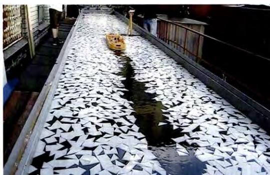
Рис. 1. След за моделью в поле битого льда толщиной 10 мм сплоченностью 8 баллов
