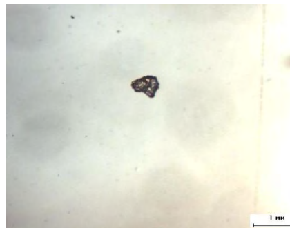
Рис. 1. Частица вязкоупругого состава до контакта с водой
