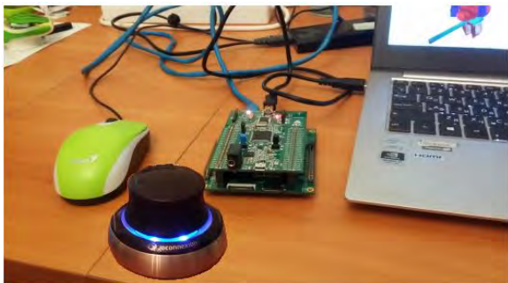
Рис. 6. Сборка из двух плат и рукоятка 3D Connexion Space Navigator
