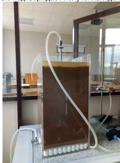
Рис. 7 Моделирование создания изоляционно-фильтрационной завесы в лаборатории (Нифонтов Ю.А. НИЛ "Геолого-геофизические технологии промышленного освоения арктических территорий и акваторий северных морей" СПбГМТУ, Никулин А.А.
