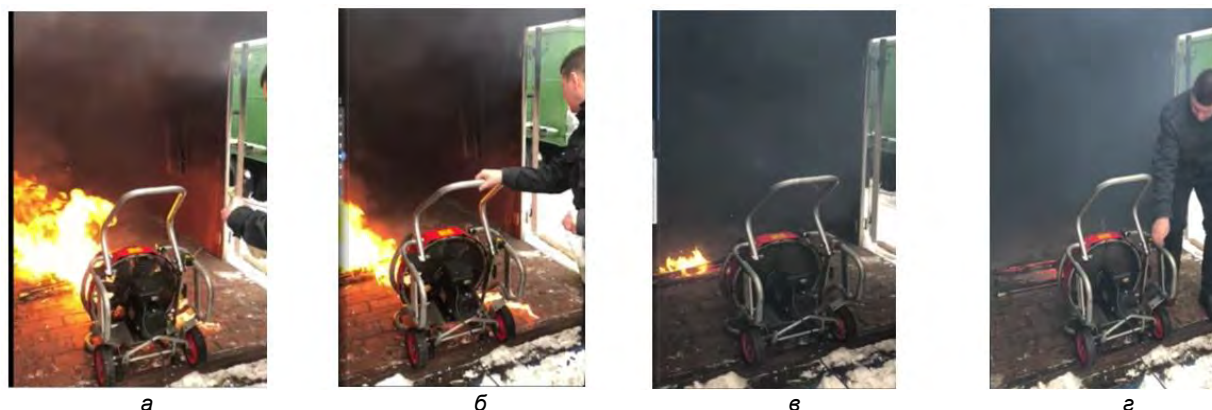
Рис.4. Демонстрационный эксперимент по тушению пожара комбинированного класса А+В (древесина, политая бензином) продувкой окружающим воздухом прибором «Буран» ДПЗ-15 при температуре 0°С проводит один из авторов статьи (а – возгорание; б – начало продувки; в – процесс подавления горения; г – завершение процесса).
