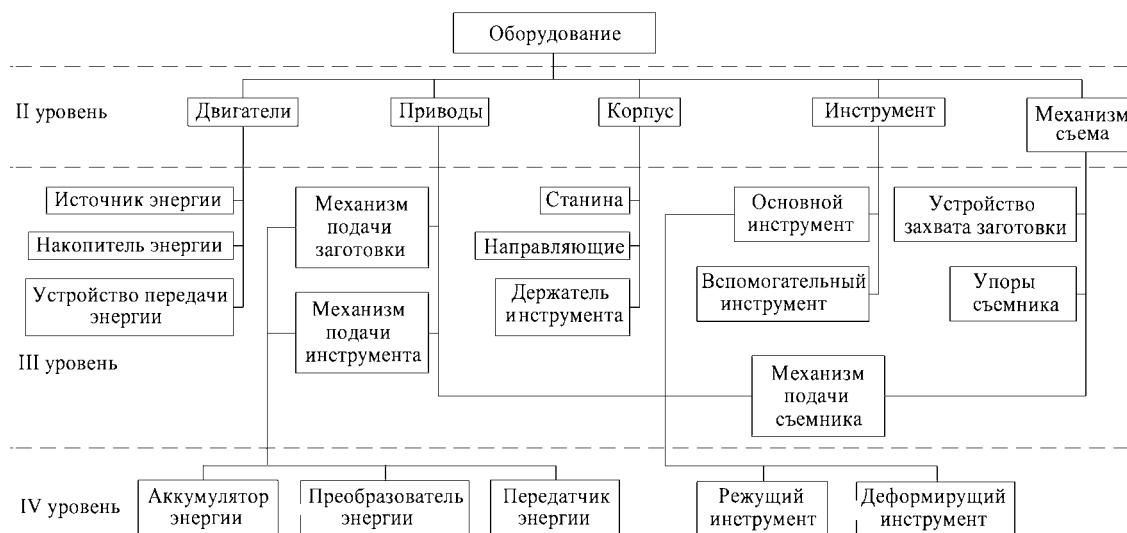
Рис. 1. Структурная модель оборудования для получения винтовых внутренних полостей трубных деталей
