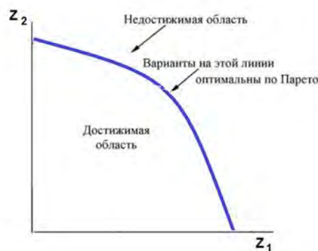
Рис. 1. Поверхность Парето для 2-х максимизируемых критериев
