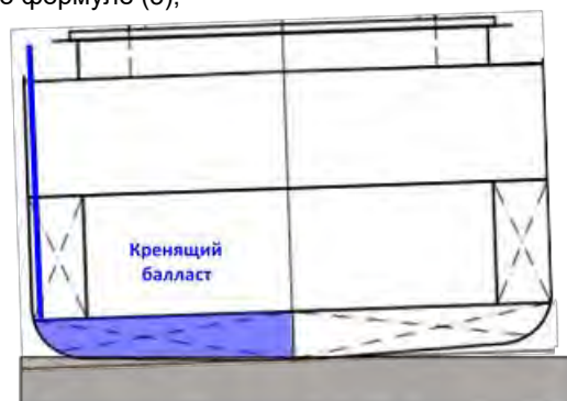
Рис. 10. Вариант использования балласта для крена и противодействия грунту
