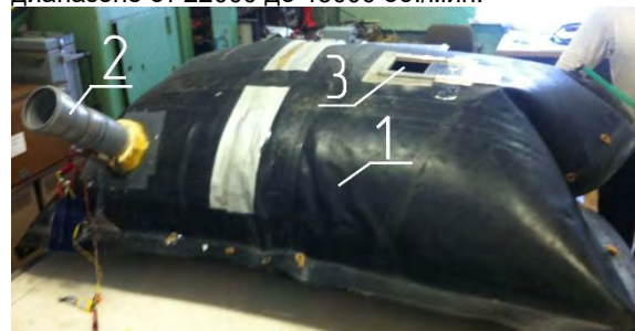
Рис. 11 Экспериментальная модель для оценки площади истечения воздуха из воздушной подушки: 1 – эластичная емкость; 2 – воздухонагнетатель; 3 – отверстие истечения с регулируемой площадью
