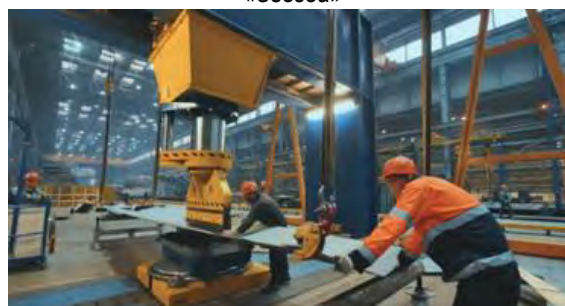
Рис. 8. Автоматический пресс для гибки по 3-D шаблонам криволинейных конструкций судов, строящихся на предприятии ССК «Звезда»
