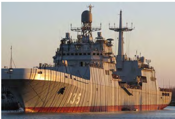
Рис. 1. Размагничивание с помощью обмоток, накладываемых на корабль временно
