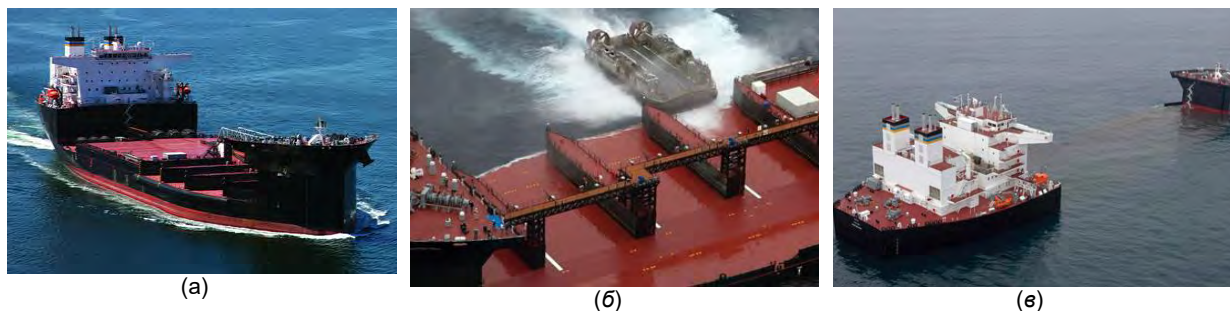
Рис. 1. Испытания десантно-транспортного корабля типа T-MLP «Montford Point» Командования морских перевозок США: а – на ходу; б – прием корабля на воздушной подушке; в – корабль в полупогруженном положении
