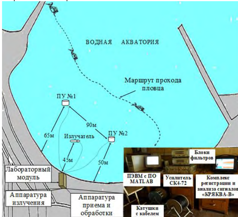
Рис. 6. Схема проведения морских экспериментальных исследований
