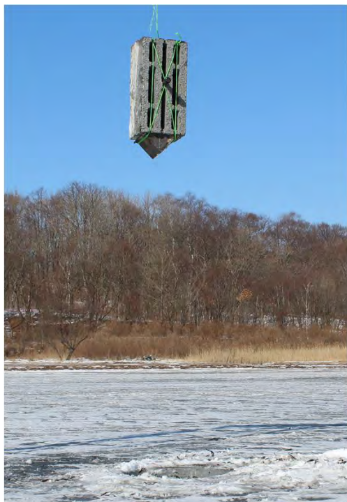
Рис. 2. Индентор с грузом перед сбросом
