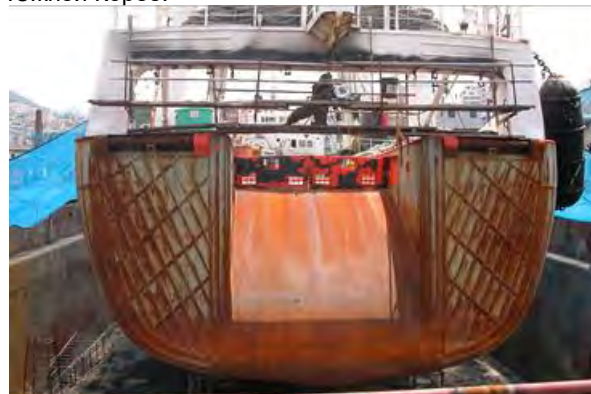
Рис. 2. Наружные усиления транца судна с необычной ориентацией приварных полос
