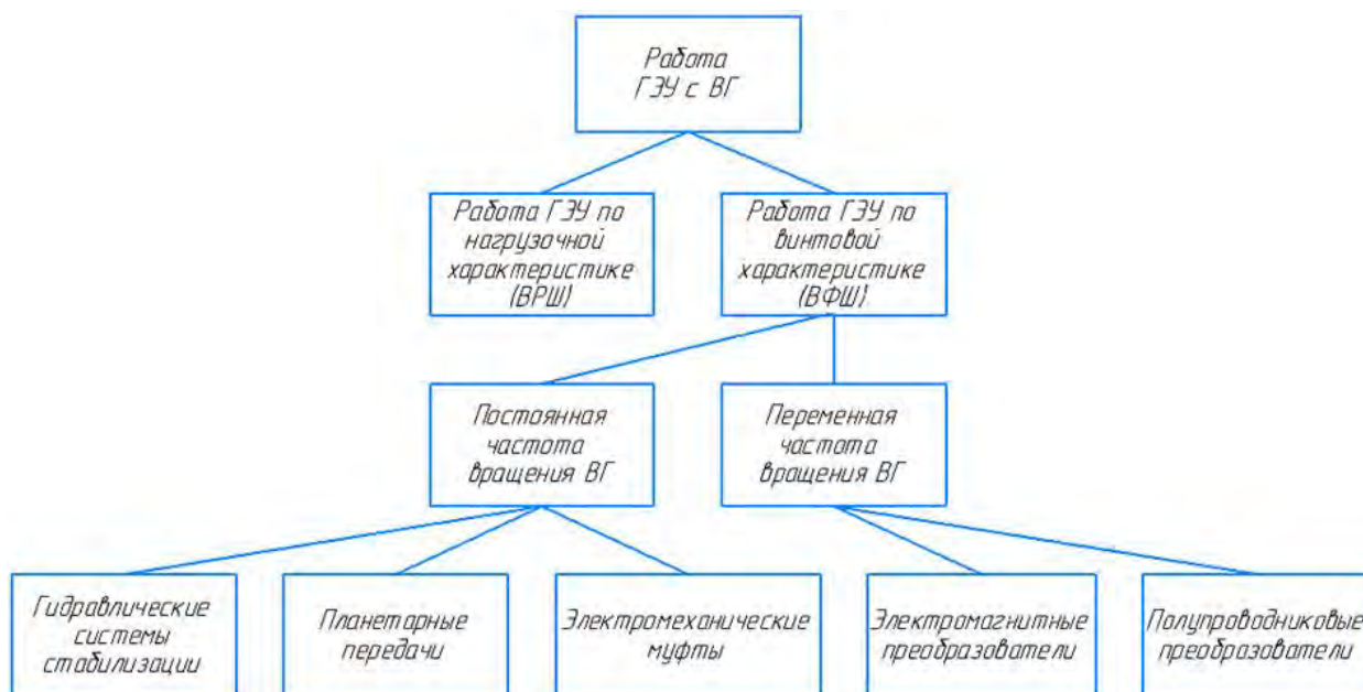
Рис. 3. Работа главной энергетической установки с валогенератором
