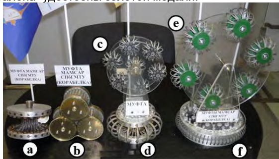
Рис. 3. Опытные образцы отдельных (a, d, f) и сборных (b, c, e) виброизолирующих муфт приводов
