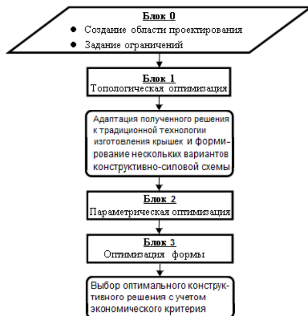
Рис. 2. Укрупнённая блок-схема алгоритма оптимального проектирования крышки
