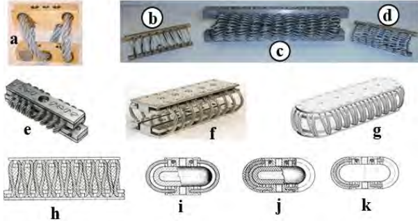
Рис. 2. Упругие виброизолирующие элементы сборных муфт
