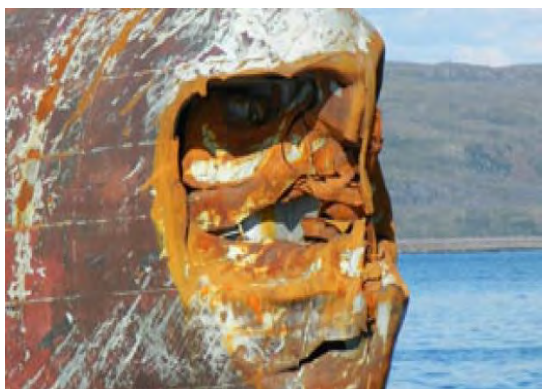
Рис. 2. Пример повреждения носовой оконечности от взаимодействия судна с дрейфующими льдинами [9]
