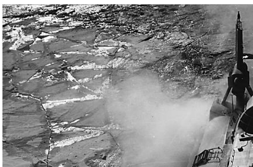
Рис.1 Измельчение крупнобитого льда за счет повторных проходов СВП
