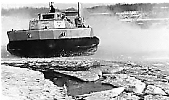
Рис.1 Разрушение ледяного покрова СВП «Скат» при его движении вблизи к береговой линии
