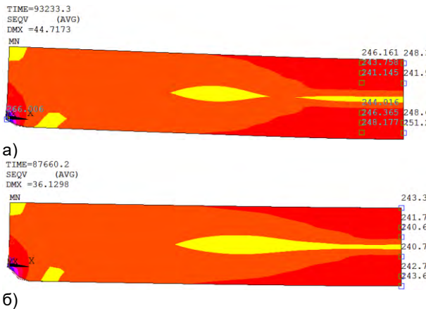
Рис.3. Предельное состояние ш. о. балки при нагрузке q : а/ E_t/E = 0.005E ; б/ E_t/E = 0.0025E
