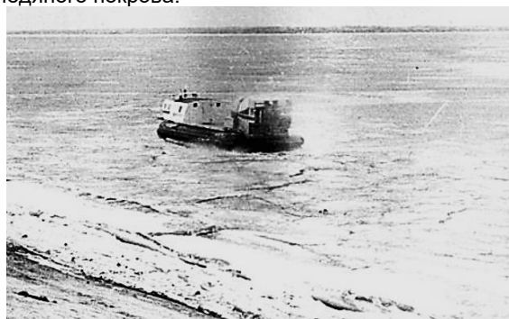
Рис.3 Разрушение ледяного покрова СВП «Тайфун» при движении с резонансной скоростью вблизи и параллельным к берегу курсом
