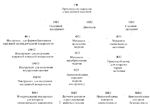
Рис. 2. Функционально-структурная модель технологии производства трубных корпусных деталей со сложными внутренними полостями: ГФ – главная функция, ОФ – основная функция, Ф – функция, ДФ – дополнительные функции
