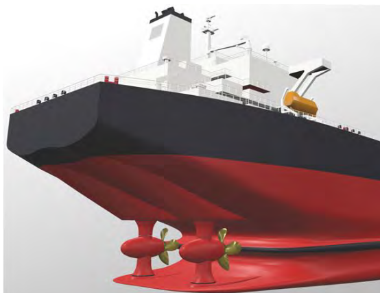
Рис. 5. Кормовая часть судна с движительной установкой, закрепленной в двух опорах вращения
