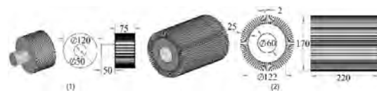
Рис. 7 – 3D модель и размеры (1) – коллектора, (2) – якоря
