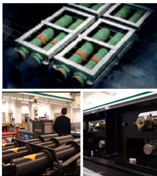
Рис. 6 Пневматические пусковые установки для изделий системы «Contralto-S» фирмы Naval Group (бывшая DCNS, Франция) [7].
