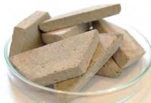
Рис. 3. Брикеты после формования и сушки ( \rho_{\text{бр.}} = 2,06 \text{ г/см}^3 )
