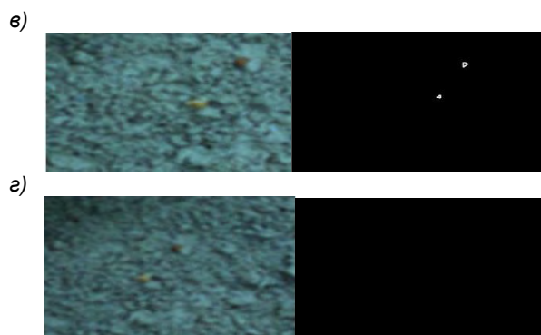
Рис. 5. Серия 3 - модельные изображения, имитирующие морское дно в водах акваторий с высоким содержанием примесей и взвешенных частиц (имитируемое количество – от 3 до 11 мг/л), а) L=20, б) L = 30, в) L = 40, г) L = 50 см.
