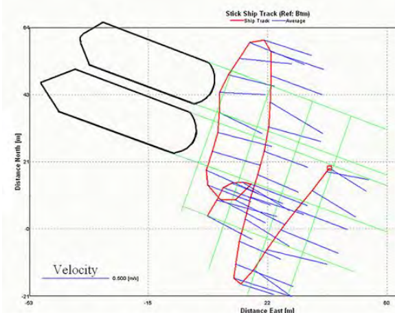
Рис. 6. Результаты измерений поля горизонтальных компонент скоростей течений за кормой счала.
