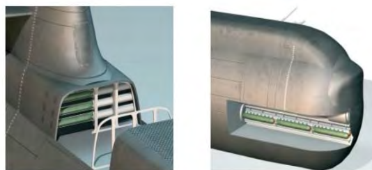
Рис. 2 Стационарные модули в межбортном пространстве (рис. 2а) и интеграция пускового устройства в стандартную трубу торпедного аппарата [6] (рис. 2б).
