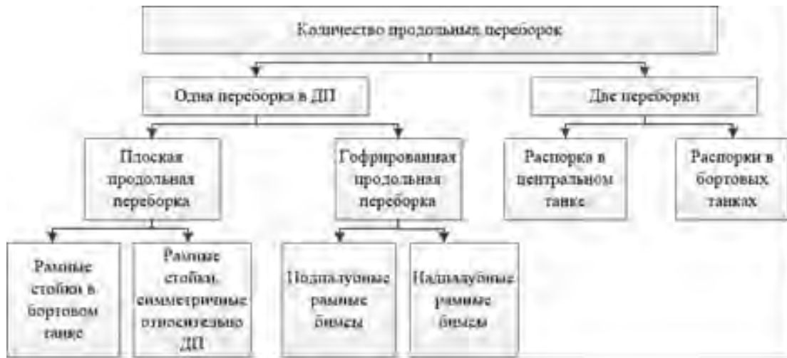
Рис. 2. Факторы, влияющие на формирование компоновочной схемы поперечной танкерной рамы
