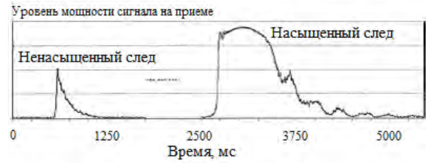
Рис. 1 – Пример осциллограмм отраженных от метеорных следов сигналов на входе приемного устройства
