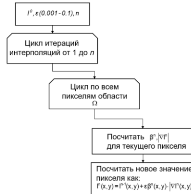
Рис. 6. Псевдокод интерполяционного замещения области \Omega
