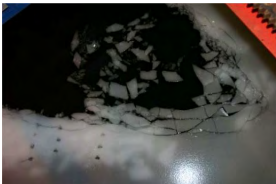
Рис. 1. Моделированный лед и его обломки на поверхности ледового бассейна университета Аалто, Финляндия Zhou et al., 2013 [2]
