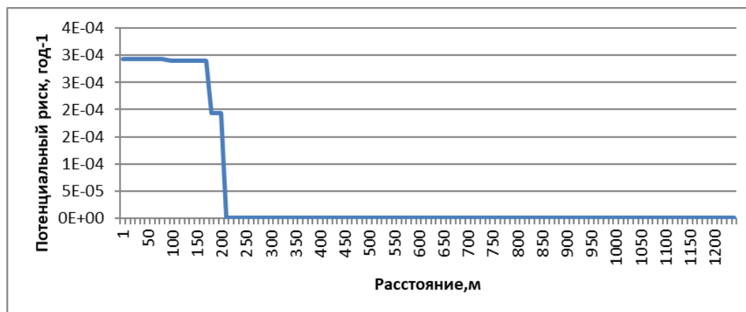
Рис. 6. Потенциальный риск при пожаре на складе угля
