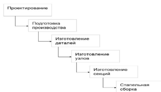
Рис. 10. Схема процессов для математической модели
