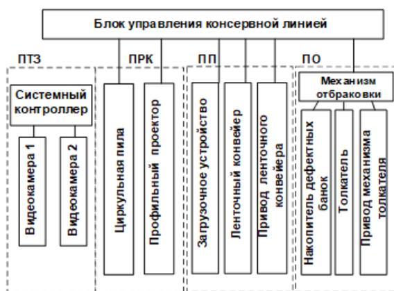
Рис. 3. Функциональная структура системы контроля герметичности консервов с использованием системы технического зрения
