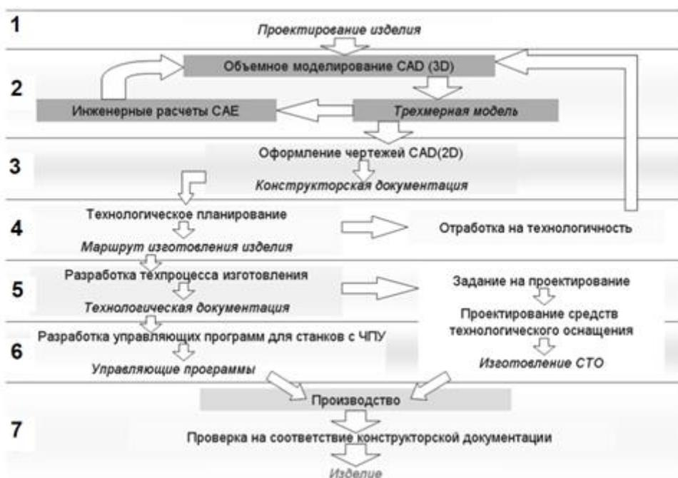
Рис. 2. Пример реализации взаимодействия бюро-производство с полным циклом выпуска РКД на стороне бюро
