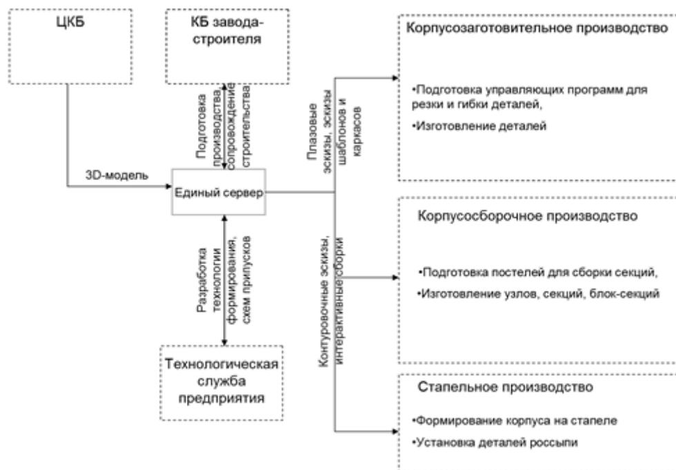
Рис. 9. Математическая модель создания корпуса на базе электронной модели
