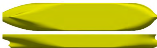
Рис. 1. Форма корпуса KVLCC2
