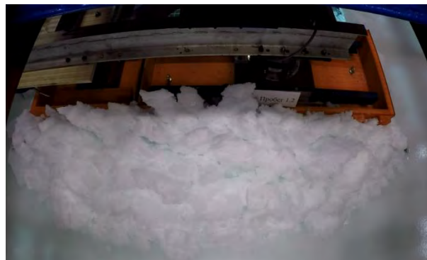
Рис. 2 – Взаимодействие причала с ровным ледяным покровом толщиной 2,44 м. Скорость дрейфа 0,3 м/с. Протяженность воздействия льда 480 м
