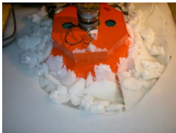
Рис. 3 Разрушение ледяного поля под весом надводного нагромождения льда
