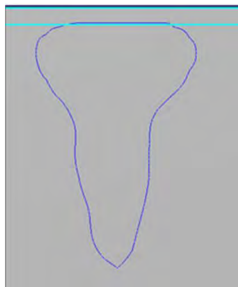
Рис. 3. Положение пятна нефти на расстоянии 100 м от дна водоёма (пятно нефти достигло поверхности, вертикальный разрез)
