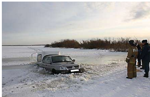
Рис. 7. Разрушение ледяного покрова при движении автомобилей в сторону берега и попытке выйти на него [9]
