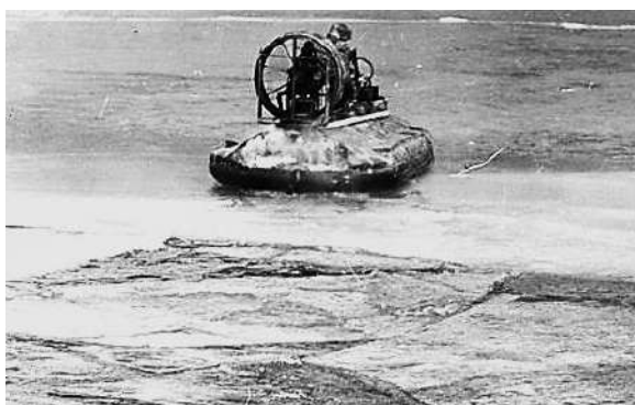
Рис. 3. Разрушение ледяного покрова крупно масштабной моделью СВП при ее выходе на берег
