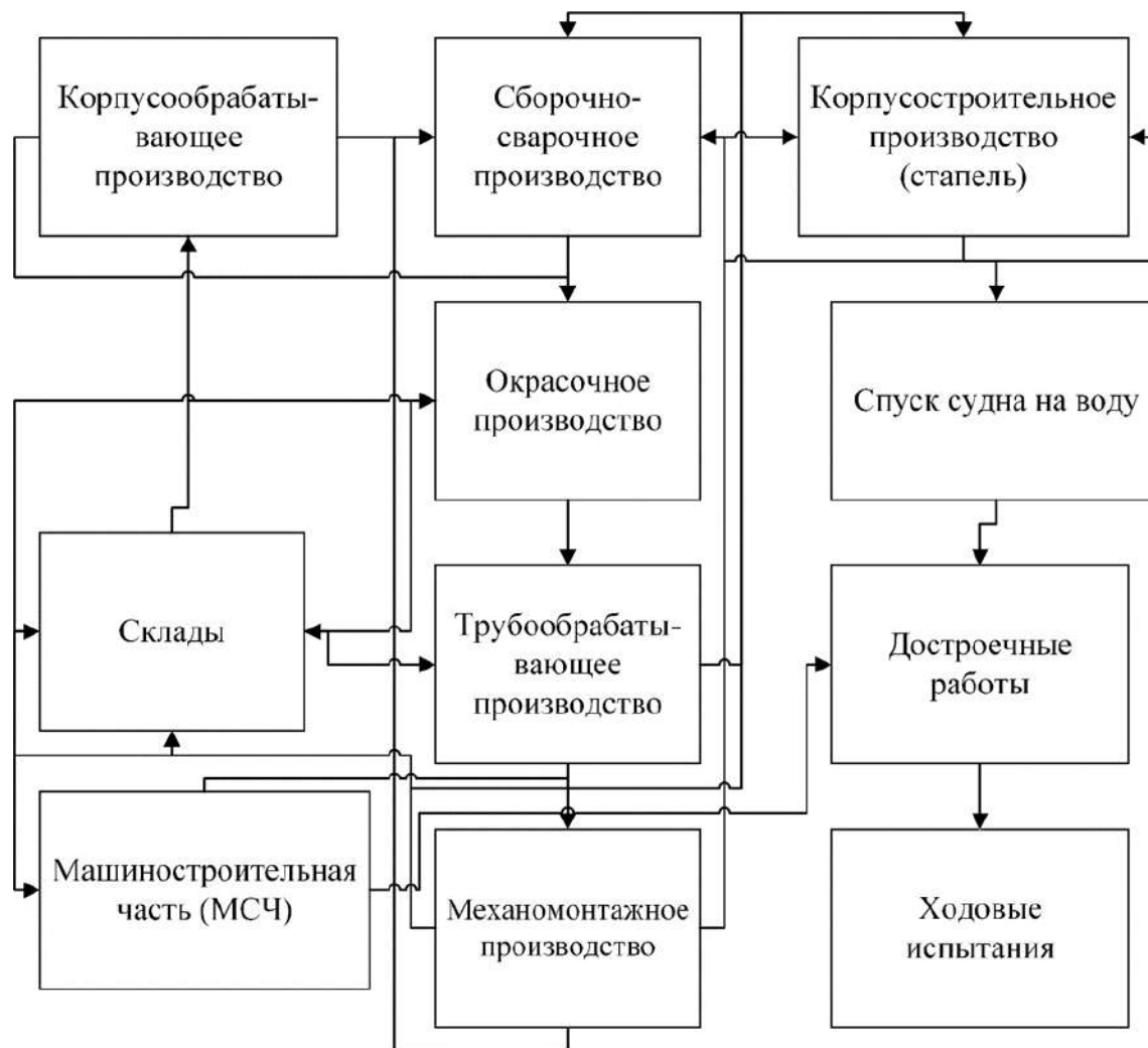
Рис. 1. Условная схема поэтапного процесса создания судостроительной продукции
