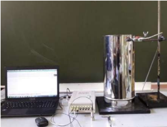
Рис. 5. Экспериментальная установка при жестком закреплении образца с одного торца D=200мм, L=450мм, б=0,5 мм из стали X17.
