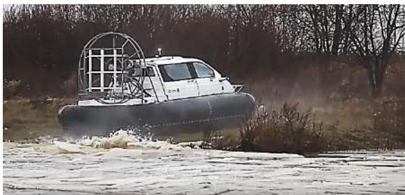
Рис. 4. За судном виден выбитый гидроударом лед [7]
