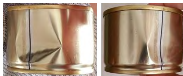
Рис. 2 - Характерные дефекты продукции в результате производства
