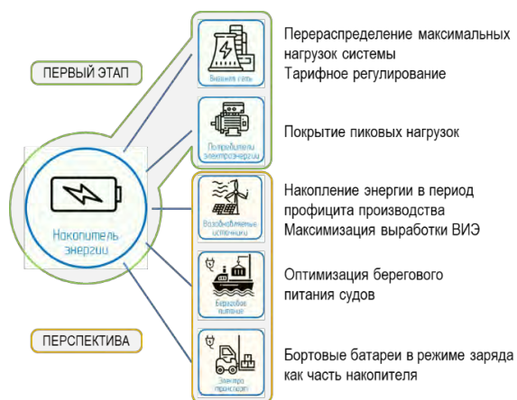
Рис. 5. Современные и перспективные направления использования накопителей электроэнергии в системах электроснабжения морских портов.
