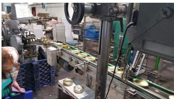
Рис. 3 - Визуальный способ контроля герметичности и геометрии упаковки шпрот в масле
