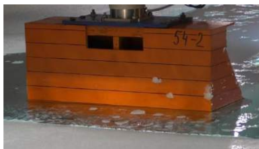
Рис. 2. Эксперименты в ледовом бассейне: а) с цилиндрическим индентором \varnothing 30 мм; б) с наклонной гранью модели шириной 700 мм; в) с вертикальной гранью модели шириной 700 мм;
