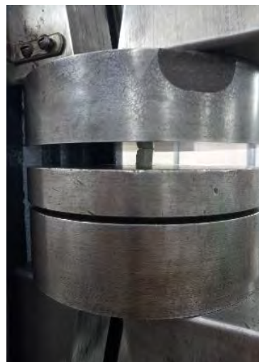
Рис. 7. Испытание образцов на машине Р-5 на сжатие
