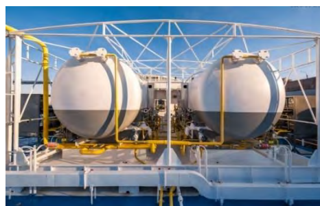
Рис. 2 Криогенно-бортовая топливная система судна «Чайка»
