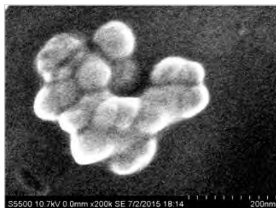
Рис. 4. Электронно-микроскопический снимок частиц сажи судового дизеля 6ЧН 24/36 при нагрузке 50% от N_{e_{ном}} , увеличение 200 тыс. раз
