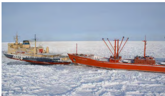
Рис. 1. Проводка ледоколом в тандеме
