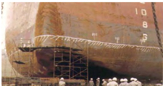
Рис. 2. Повреждения днища танкера [4].
