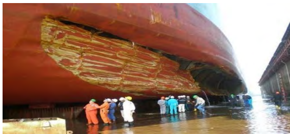
Рис. 5. Ледовое повреждение бортового перекрытия
