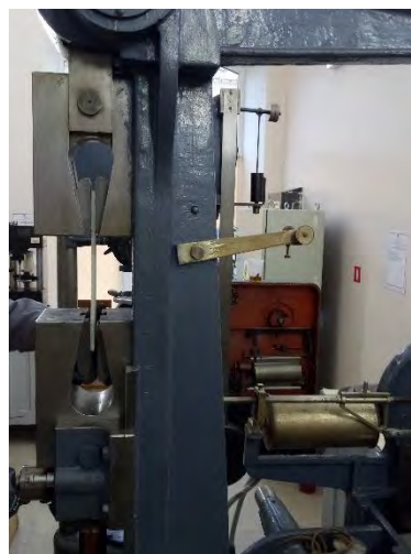
Рис. 4. Испытание образцов на машине Р-5 на растяжение
