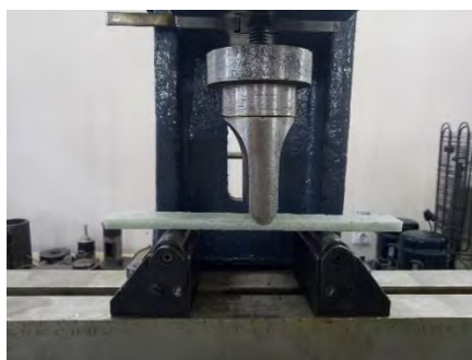
Рис. 10. Испытание образцов на машине Р-5 на трехточечный изгиб
