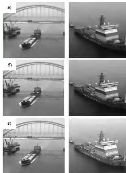
Рис. 3. Результаты сжатия и восстановления Морских изображений (случае 0,3 бит/пиксель): а) ДКП, б) АДКП и в) ДВП
