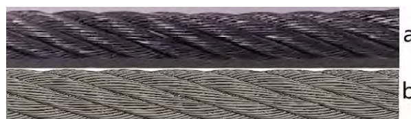
Рис. 5 – Канатный стержень диаметром 12 мм длиной 90 мм
