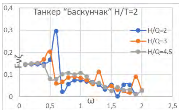
Рис. 5. Значения вертикальной возмущающей силы, возникающие при качке двух судов «Баскунчак» параллельно вертикальной стенке в зависимости от изменения расстояний до нее и между судами при H/T=2
