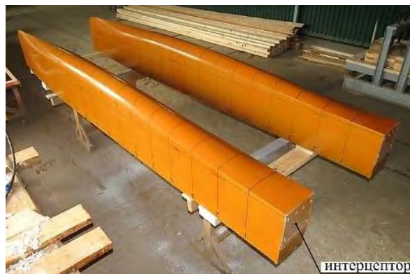
Рис. 3. Фотография модели катамарана без выступающих частей с установленными на транцах корпусов интерцепторами
