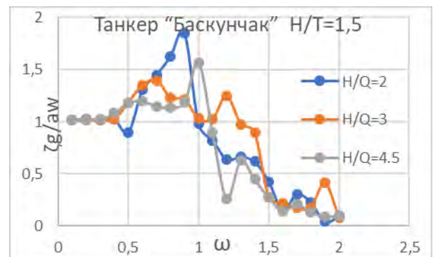
Рис. 11. Значения АЧХ вертикальной качки, возникающие при качке двух судов «Баскунчак» параллельно вертикальной стенке в зависимости от изменения расстояний до нее и между судами при H/T=1,5
