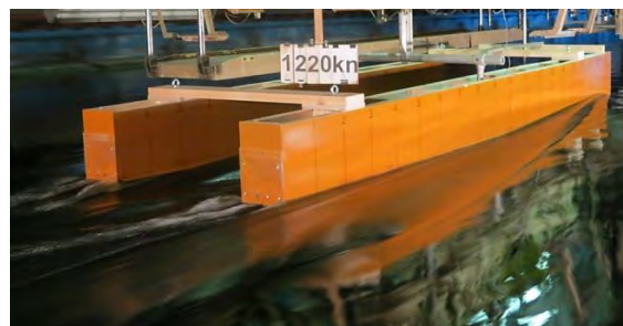
Рис. 8. Фотография модели катамарана, сделанная во время испытаний на тихой воде
