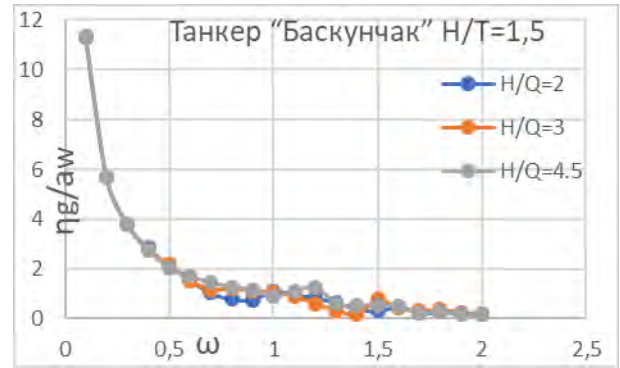
Рис. 10. Значения АЧХ поперечно-горизонтальной качки, возникающие при качке двух судов «Баскунчак» параллельно вертикальной стенке в зависимости от изменения расстояний до нее и между судами при H/T=1,5
