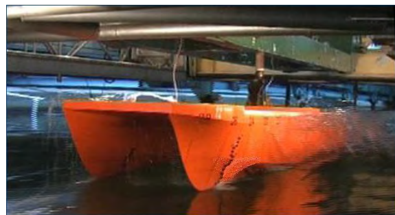
Рис. 11. Испытания модели катамарана в мореходном бассейне
