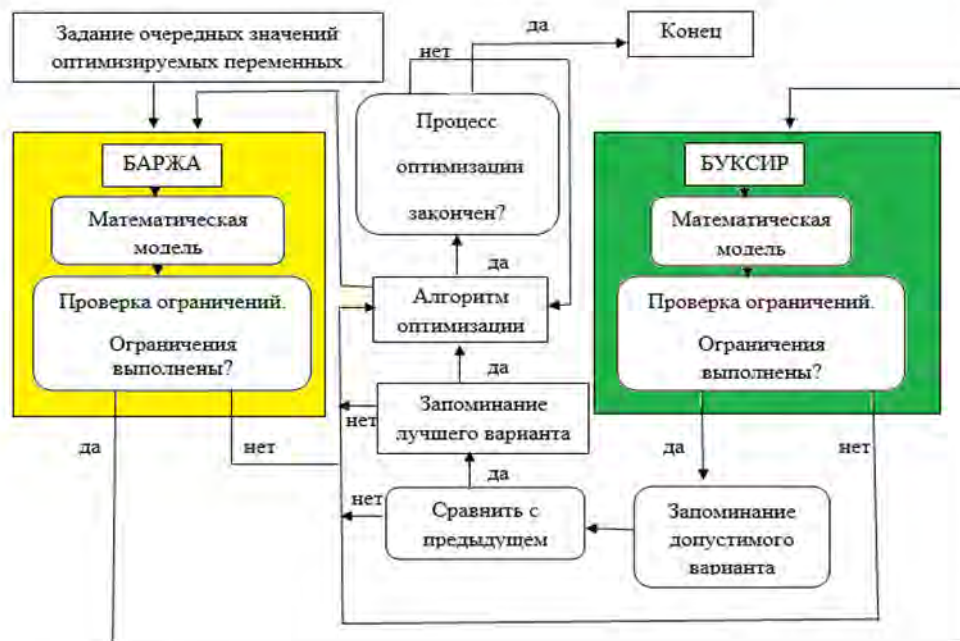
Рис.4. Схема структуры имитационного программно-методического модуля ББК
