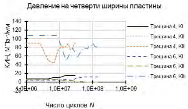
Рис. 19. Изменение КИН в случае приложения пятна нагрузки на четверти ширины пластины
