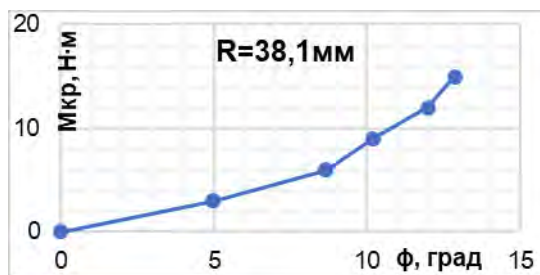
Рис. 12 – Нагрузочные характеристики одного дезаксиального с радиусом 38,1 мм канатного стержня, полученная МКЭ
