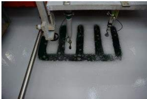
а) Измерение прочности льда при изгибе
