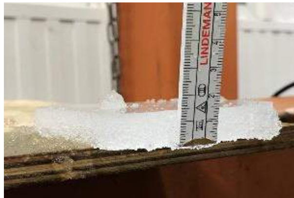
б) Измерение толщины льда
