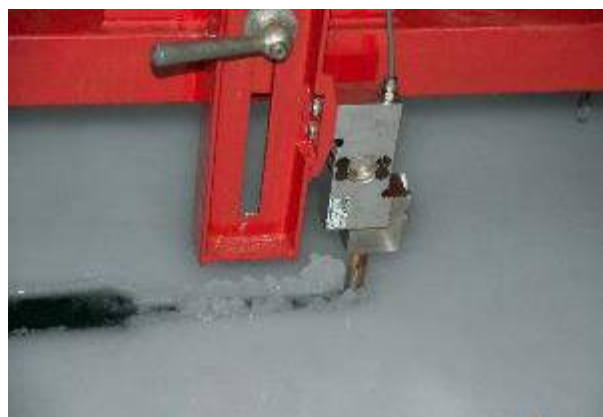
г) Измерение прочности льда при сжатии
