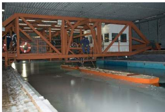
Рис. 1. Проведение модельных испытаний в ледовом бассейне Крыловского Центра во льду, изготовленном по технологии FG
