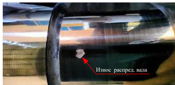
Рис. 4. Износ распределительного вала судового ВОД фирмы "Катерпиллар" C32 ACERT наработка 18 тыс. часов
