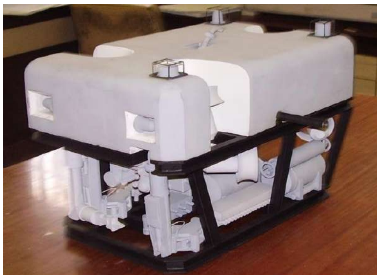
Рис. 3 Модель ТНПА для исследования в аэродинамической трубе
