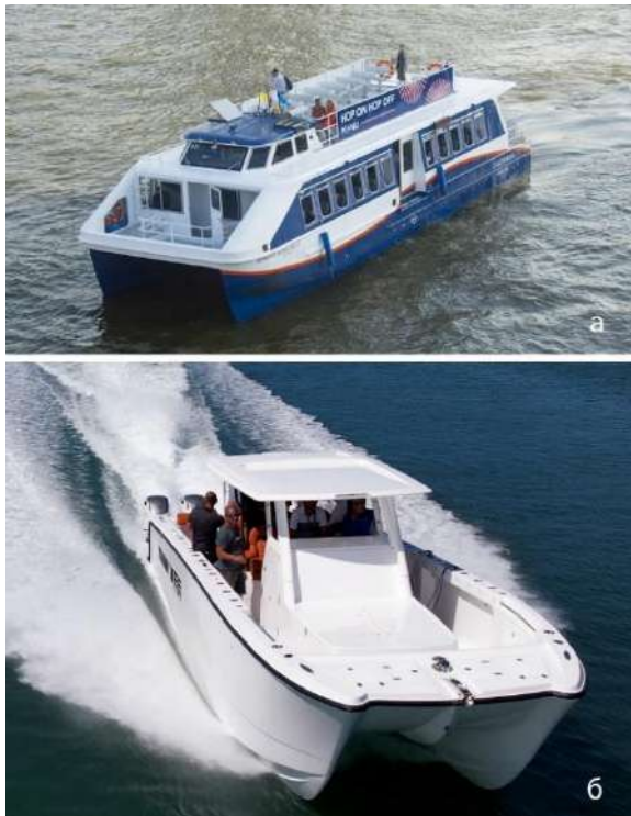
Рис. 1. Малые суда по проектам АНМК а) алюминиевый пассажирский катамаран длиной 18м в (Таиланд) б) рекреационный катамаран из композитов длиной 12м (США)
