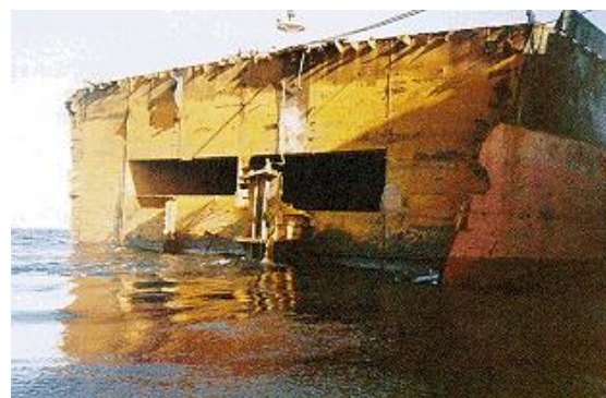
Рис. 2. Отрыв носовой оконечности танкера «Kirki» [5]
