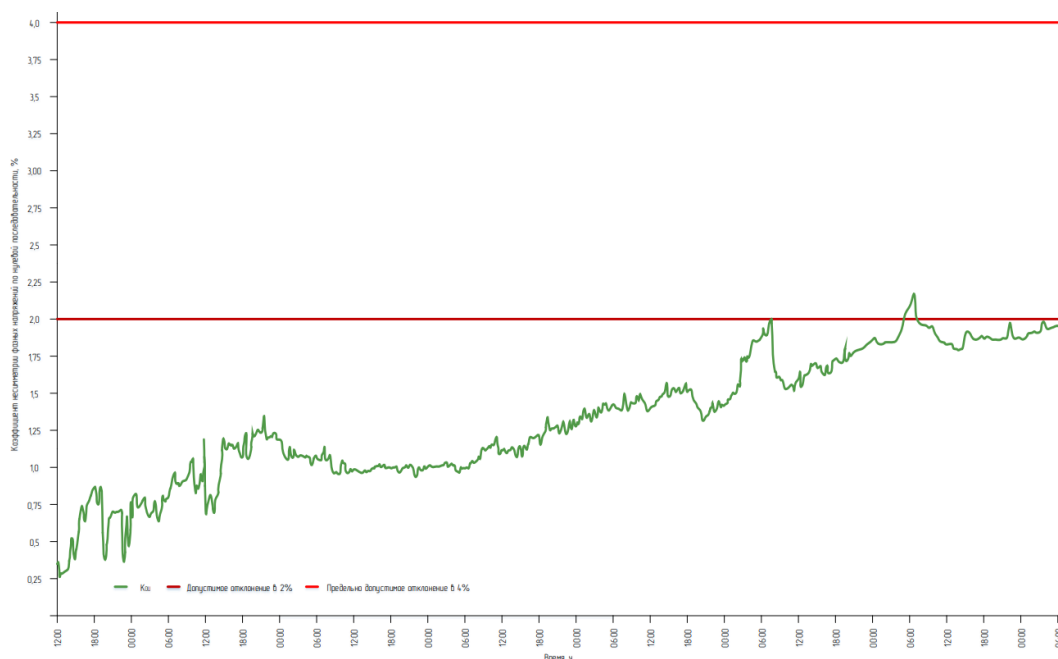
Рис. 3. Зависимость коэффициента несимметрии напряжений по нулевой последовательности на шинах 0,4 кВ цеховой подстанции судостроительного завода
