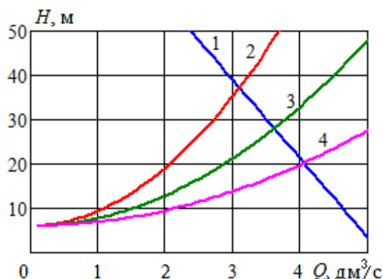
Рис. 5. Влияние диаметра трубопровода на положение рабочей точки: 1 – характеристика насоса; 2 – характеристика трубопровода при d = 31 мм; 3 – при d = 36 мм; 4 – при d = 42 мм
