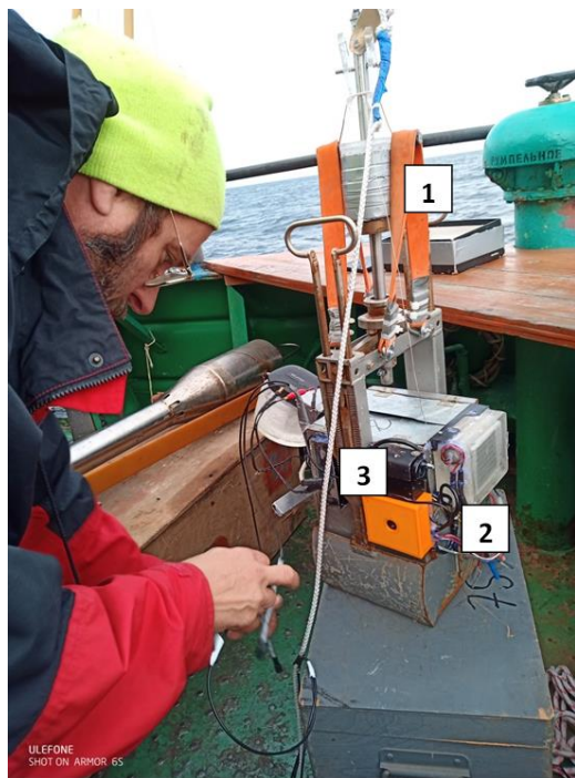
Рис. 1. Текущий вариант модифицированного дночерпателя с основными модулями: 1 - имитатор посылы; 2 – блок электроники; 3 –сервопривод
