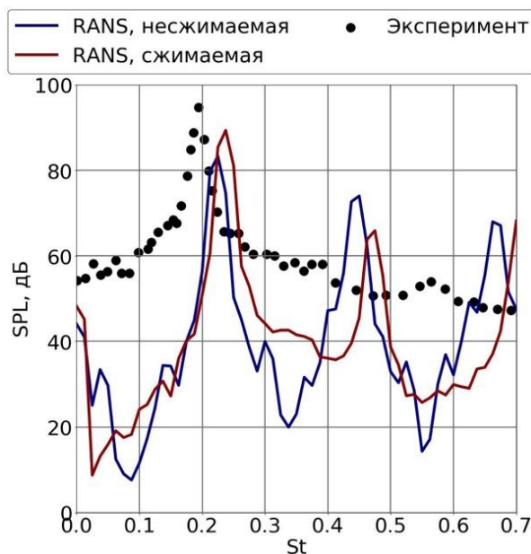
Рис. 6. Уровни звукового давления для сжимаемой и несжимаемой сред, метод RANS
