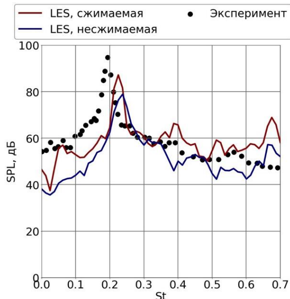
Рис. 5. Уровни звукового давления для сжимаемой и несжимаемой сред, метод LES
