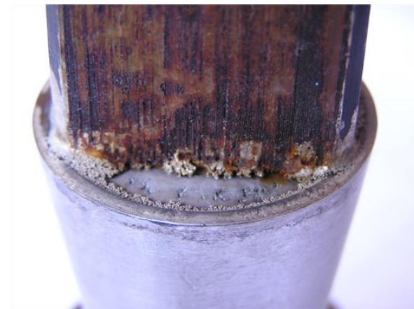
Рис. 7. Кавитационный износ паяного соединения
