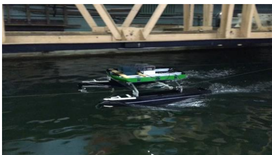
Рис. 2. Картина обтекания аппарата при скорости хода 1,48 м/с
