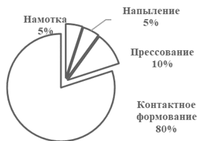
Рис. 1. Основные методы изготовления корпусных конструкций из стеклопластика
