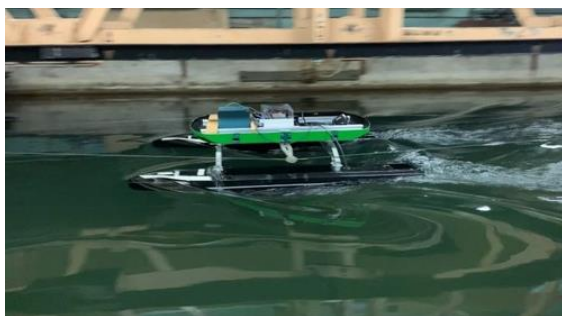
Рис. 3. Картинка обтекания аппарата при скорости хода 1,65 м/с
