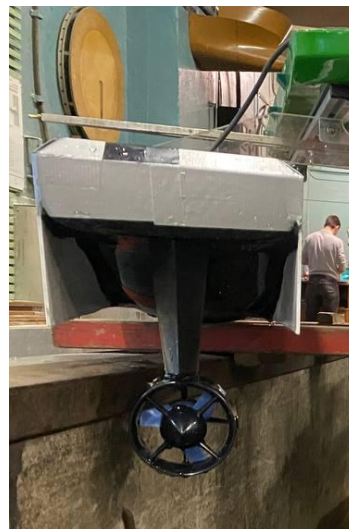
Рис. 9. Результаты модернизации построенного корпуса с целью улучшения его ходовых характеристик
