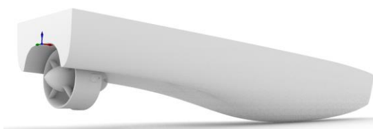
Рис. 5. Трехмерная модель корпуса с туннельными кормовыми обводами и круглой скулой: общий вид (сверху) и вид с установленным движителем BlueRobotics T200 (снизу)
