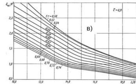
Рис. 2 .Диаграмма группы "L/B" для расчета остаточного сопротивления катамаранов  $\zeta_{rest}^{L/B}$
