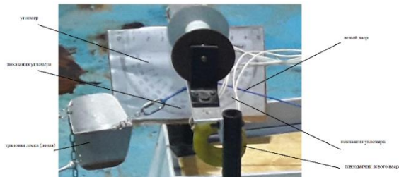
Рис. 8. Замер натяжения в тензодатчике, снятие показаний угломера
