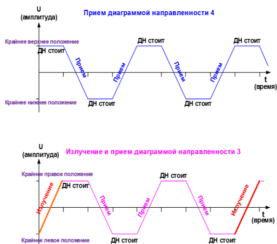
Рис. 10. Физическая модель акустической системы для измерения координат объекта гидролокатором бокового обзора
