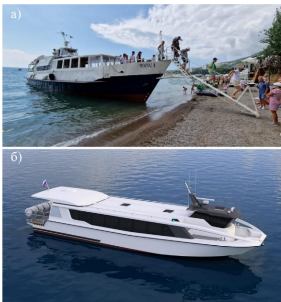
Рис. 1. Малые пассажирские суда: а) – стальной теплоход «Форос-1» постройки 1973 года высаживает людей на необорудованный берег; б) - перспективное пассажирское судно из композиционных материалов с носовой аппарелью пр. AMD1990, в РФ подобные морские суда де-факто запрещены.
