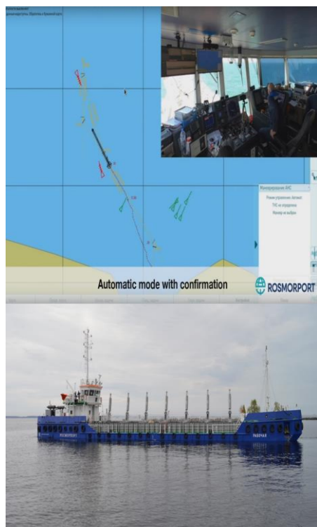
Рис. 2. Грунтоотвозная шаланда «Рабочая», оборудованная системой а-Навигации Sitronics KT, управляемая с борта земснаряда «Редут» в автоматическом режиме
