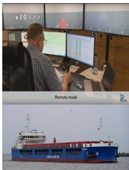
Рис. 3. Т/х «Пола Анфуса», оборудованный системой а-Навигации Sitronics KT, управляемый специалистами из петербургского офиса группы «Пола Райз» в дистанционном режиме
