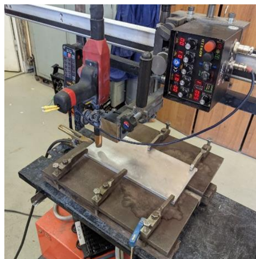
Рис. 1. Установка для выполнения наплавки.
