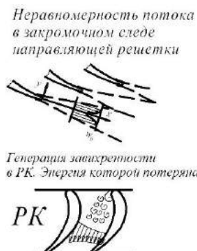
Рис. 4. Иллюстрация конфигурации потока за СА и в РК
