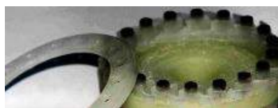
Рис. 7. Покрывной диск центробежных лопаток 1 – покрывной диск; 2 – пальцы; 3 – рабочие лопатки
