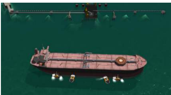
Рис. 2. Швартовка крупнотоннажного судна к терминалу с использованием АБА
