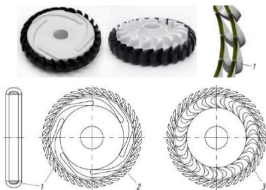
Рис. 3. Турбина базовой конструктивной схемы 1 – ПНА; 2 – центробежный сопловой аппарат; 3 – центростремительные рабочие лопатки
