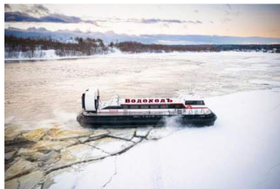
Рис. 1. Увеличение ледоразрушающей способности ИГВ при выходе судна на мелководье (судно выходит на берег)
