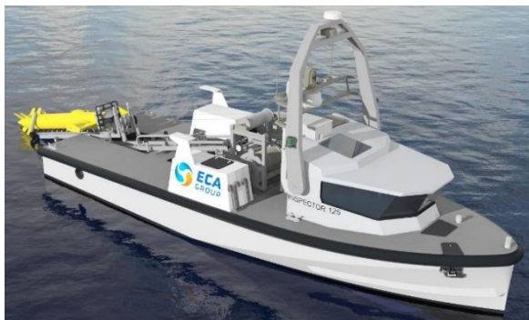
Рис. 14. БЭК «Inspector 125» (длина – 12,33 м, осадка – 0,7 м, ширина – 4,2 м, высота – 3,8 м, масса – 18,1 м, скорость максимальная 25 уз, автономность – 40 ч, удаленность от СН – 12 миль, мощность ПН – 2 кВт, масса ПН – 3 т)
