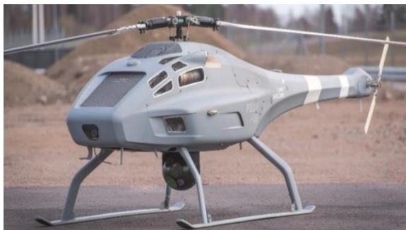
Рис. 15. БПЛА UMS Skeldar V200 (длина – 4,03 м, ширина – 1,2 м, высота – 1,3 м, диаметр винта – 4,7 м, масса – 205 кг, скорость – 140 км/ч, автономность – 6 ч, удаленность от СН – 100 км, масса ПНТ – 40 кг, высотный потолок – 3 км)
