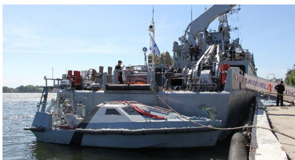
Рис. 11. Корабль ПМО пр. 12700 и БЭК «Inspector Mk2» (длина – 9 м, ширина – 2,9 м, высота – 3,5 м, масса – 4,3 т, масса ПН – 600 кг, скорость максимальная – 35 уз)
