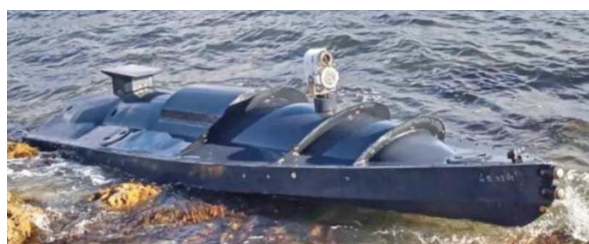
Рис. 3. БЭК неустановленной модели на берегу Черного моря в районе г. Севастополь (длина – 5,5 м, масса – 1 т, масса полезной нагрузки (ПН) – 200 кг, скорость максимальная – 40 уз)
