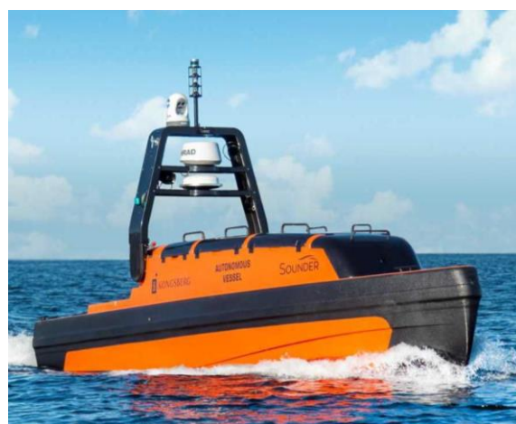
Рис. 4. БЭК «Sounder» компании Kongsberg Maritime (длина – 8 м, ширина – 2,2 м, высота – 4,4 м, масса – 4,2 т, скорость 12 уз, автономность – 20 сут., при скорости 4 уз, энергетическая установка (ЭУ) – дизельный двигатель 125 л.с., мощность для ПН – 4 кВт)
