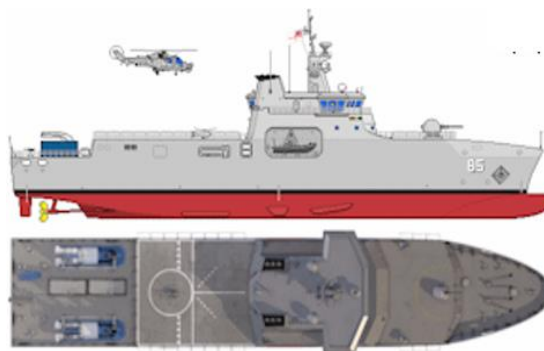
Рис. 12. Проект корабля-носителя «Venari-85» (длина – 85,9 м, скорость максимальная – 22 уз, экипаж 59 чел., ПН – 500 т, автономность – 30 сут, дальность плавания – 5000 миль)
