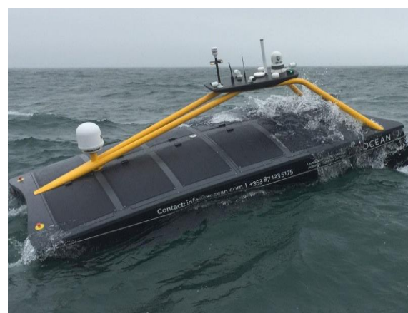
Рис. 5. БЭК «ХО-450» компании HOCEAN (длина – 4,5 м, ширина – 2,2 м, высота – 2,2 м, масса – 750 кг, масса ПН – 100 кг, скорость – 4 уз, автономность – 18 сут., дальность плавания – 1512 миль, ЭУ – комбинированная: дизель-генератор/Li-ion/солнечные панели)
