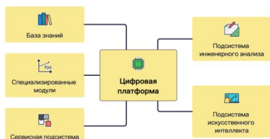
Рис. 3. Предлагаемый вариант архитектуры цифровой платформы проектирования
