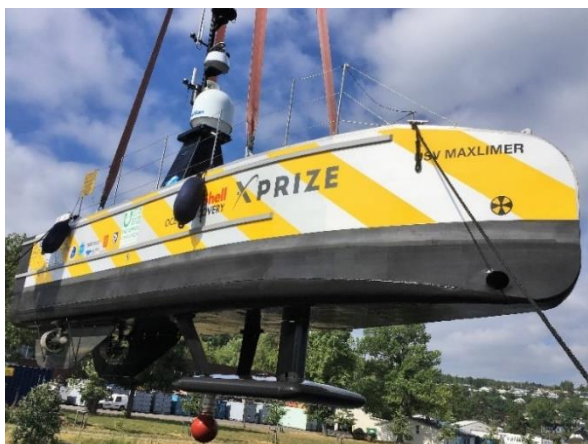
Рис. 7. БЭК «Maxlimer» компании SEA-KIT (длина – 11,74 м, осадка – 0,72 м, ширина – 2,2 м, высота 8,45 м, масса – 11,2 т, скорость максимальная – 6 уз, масса ПН – 2 т)
