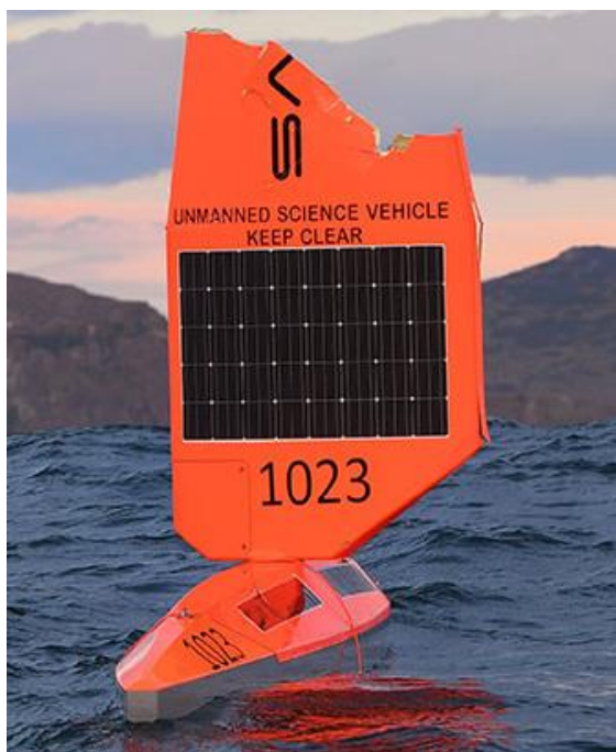
Рис. 6. БЭК «SD 1023» компании Saildrone с поврежденным жестким парусом (длина – 7 м, осадка – 2 м, высота – 4,6 м, масса – 545 кг, скорость – до 8 уз, автономность – 12 мес., дальность плавания – без ограничений, ЭУ – Li ion/солнечные панели/жесткий парус, мощность ПН – 2 кВт, масса ПН – 100 кг)
