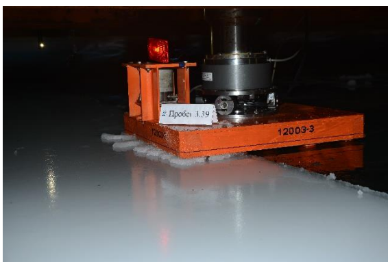
Рис. 2. Воздействие обломка ледового поля на швартовый пал под прямым углом
