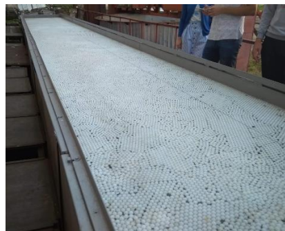
Рис. 3. Бассейн с битым (моделированным) льдом в виде гранул полиэтилена
