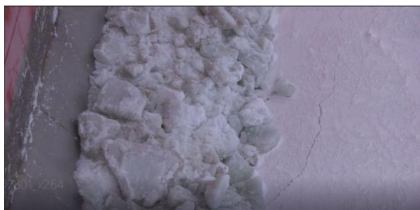
Фото. Появление окружных трещин при контакте ровного поля с образующимся навалом у наклонной грани платформы.
