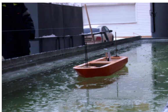
Рис. 6. Испытания модели ледокола пр.21900 в битом льду
