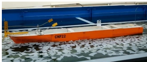
Рис. 5. Модель судна пр. CNF22 при движении носом во льду сплоченностью 4 балла
