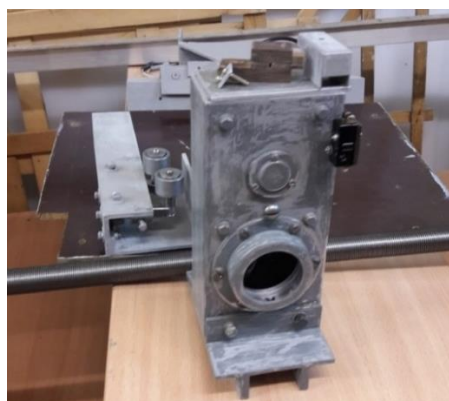
Рис. 16. Мотор – редуктор привода малых скоростей
