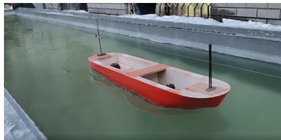
Рис. 8. Движение модели ледокола пр. 21900 в сплошном льду толщиной 2,0 мм
