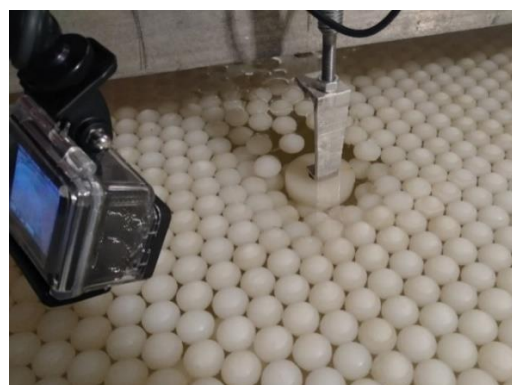
Рис. 3. Проведение опыта по разрушению композитной модели ледяного покрова
