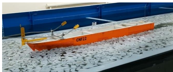
Рис. 6. Модель судна пр. CNF22 при движении носом во льду сплоченностью 8 баллов
