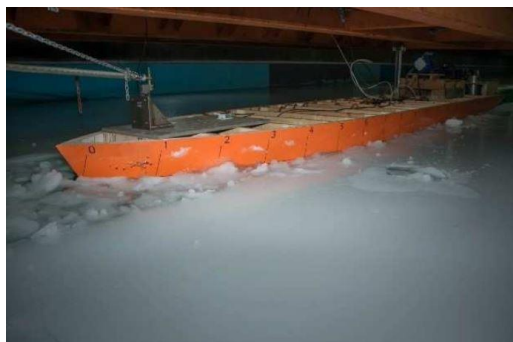
Рис. 4. Буксировочные испытания модели крупнотоннажного транспортного судна в канале за ледоколом
