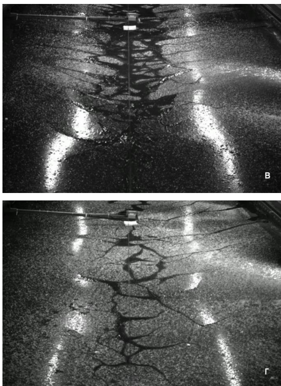
Рис. 6. Разрушение модельного льда ИГВ от движения модели №1
