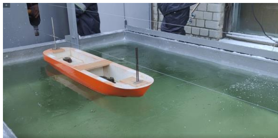
Рис. 7. Установка модели ледокола пр. 21900 перед движением
