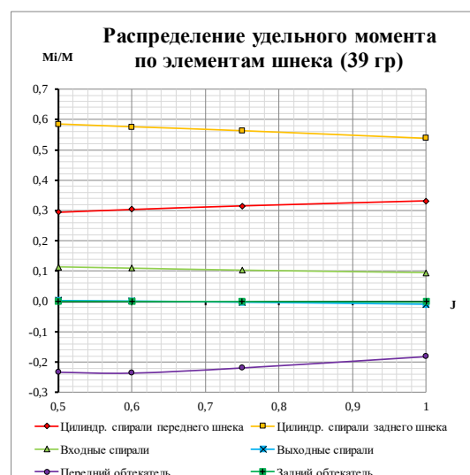
Рис. 3. Распределение удельного момента по элементам шнекового движителя на ходовом и швартовном режимах
