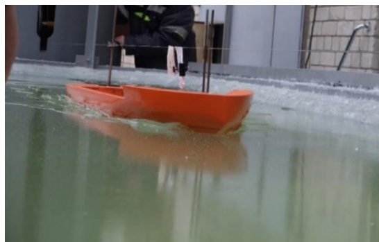
Рис. 4. Движение модели в тонком естественном льду толщиной 1,5 мм
