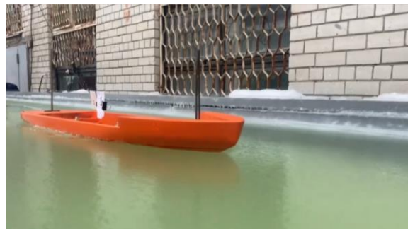
Рис. 9. Движение модели ледокола пр. 01105 в сплошном льду толщиной 4,1 мм
