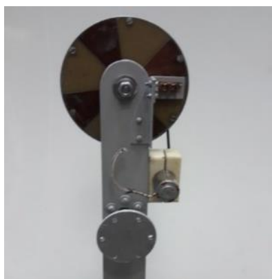
Рис. 12. Аналоговый датчик скорости и пройденного пути
