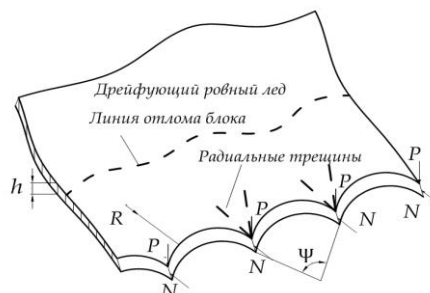
Рис.3. Представление контактного края поля цепочкой дуг.
