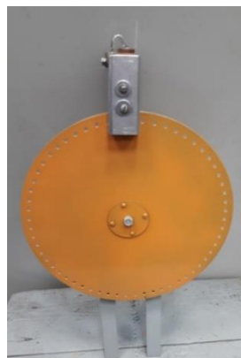
Рис. 15. Диск светимпульсного измерения скорости
