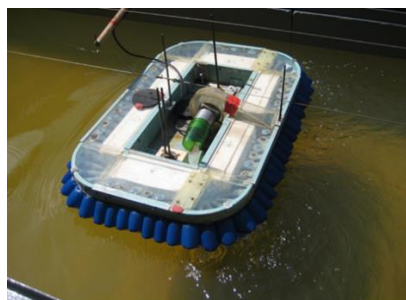
Рис. 2. Фрагмент испытания ЛПВП в чистой воде
