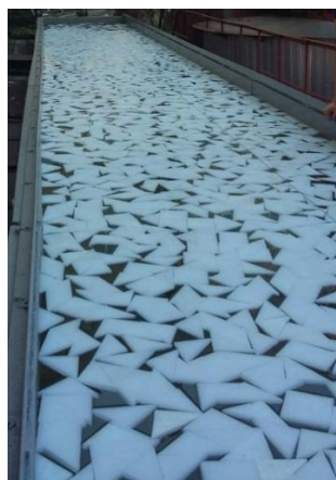
Рис. 2. Бассейн с битым (моделированным) льдом в виде треугольных плиток полиэтилена
