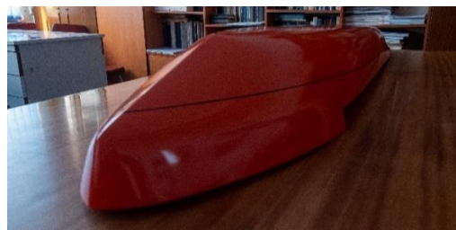
Рис. 2. Модель ледокола проекта 1105 (масштаб 1:50)
