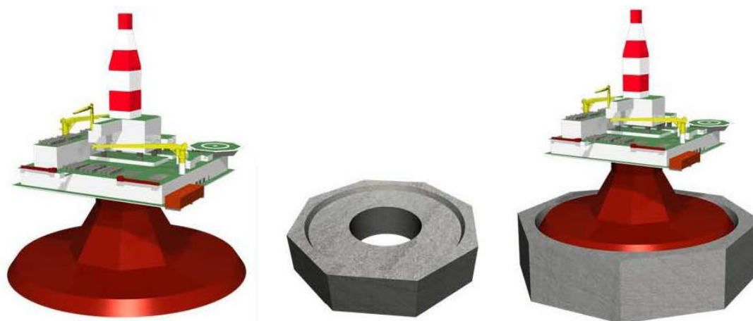
Рис. 2. Погружная комбинированная буровая установка с железобетонным опорным основанием (подставкой)
