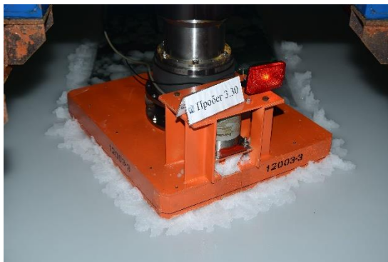
Рис. 1. Воздействие ровного льда на швартовый пал под косым углом
