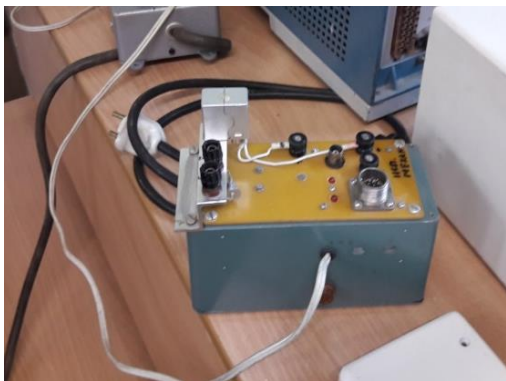
Рис. 17. Формирователь сигнала цифровой скорости и автоматическое управление замком динамометра
