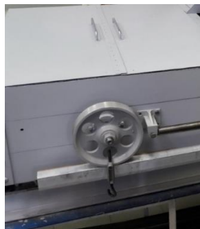
Рис. 14. Заднее ведущее колесо буксировочной тележки
