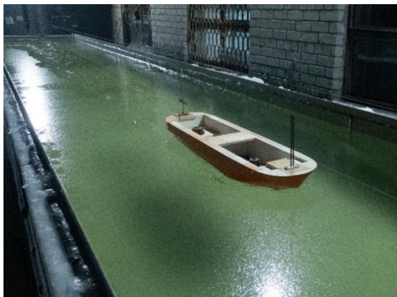
Рис. 5. Испытания модели ледокола пр.21900 в сплошном льду
