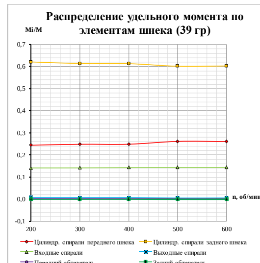
Рис. 3. Распределение удельного момента по элементам шнекового движителя на ходовом и швартовном режимах
