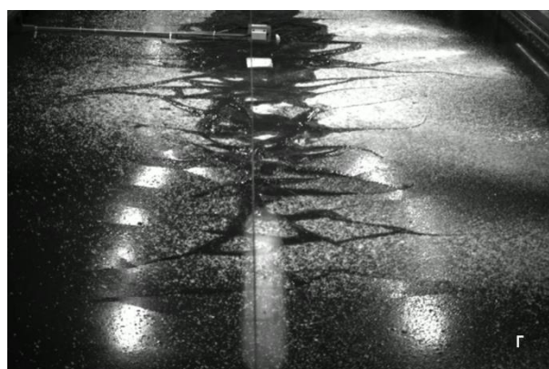
Рис. 12. Разрушение модельного льда ИГВ от движения моделей погруженных тел при Fr=0,39 а) модель №2; б) модель №3; в) модель №2.1; г) модель №3.1
