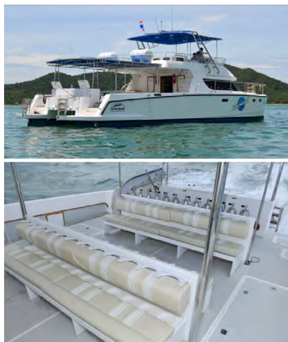
Рис. 5 – Катамаран пр. AT1600 для перевозки дайверов. Предусмотрены спуск к воде в кормовой части и специальные сиденья, позволяющие устанавливать акваланги.
