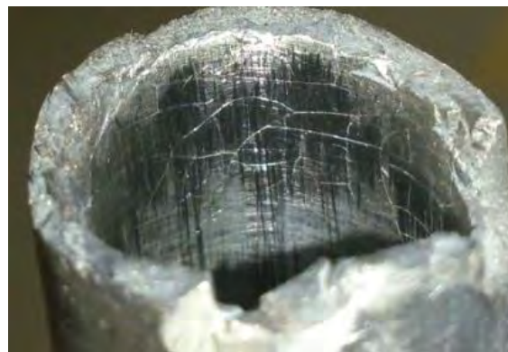
Рис. 8. Место разрушения в зоне наводороживания коллекторной питательной трубы ПГ а/л «Таймыр»
