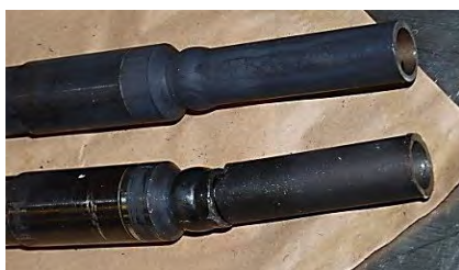
Рис. 6. Дроссельный пакет ПГ-28 с выделенными зонами отрыва труб
