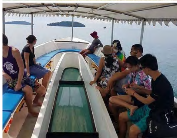
Рис. 6 – Судно со стеклянным днищем пр.МGB10. Виден колодец, позволяющий сохранить плавучесть судна в случае повреждения стекла.
