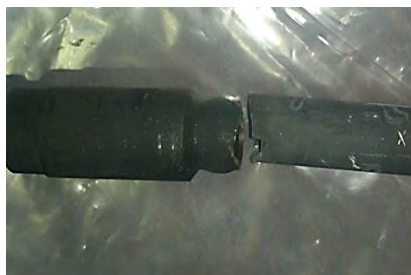
Рис. 7. Зоны отрыва коллекторных питательных труб ПГ-28 на атомных ледоколах а) «Вайгач», б) «Россия», в) «Таймыр»
