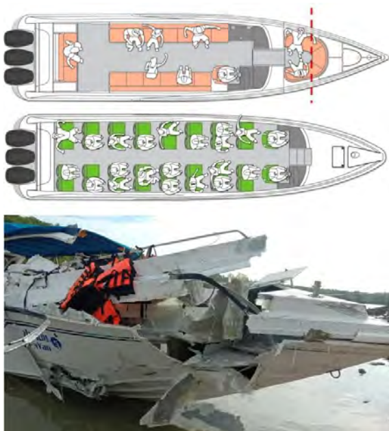
Рис. 9 – Опасная и безопасная компоновка «спидбота»; внизу – последствия столкновения
