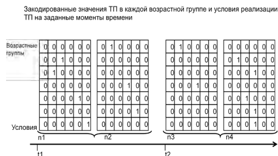
Рис. 7. Пример разреженного кодирования значений ТП и условий их проявления в виде последовательностей пар булевых матриц
