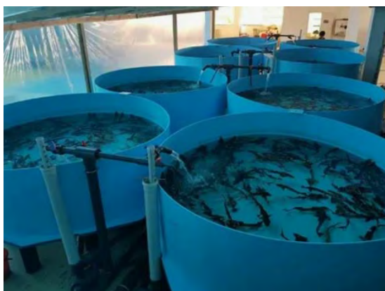
Рис. 2. Установка замкнутого водоснабжения
