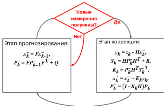
Рис. 3. Процесс работы фильтра Калмана
