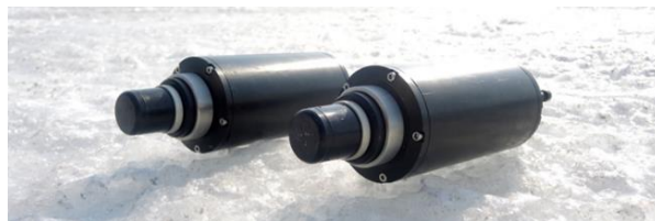
Рис. 3 Гидроакустические модемы ООО «Аквателеком» ATM-28 (частотный диапазон 24-32 кГц)
