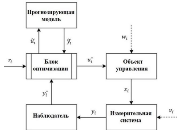
Рис. 4. Структурная схема работы системы управления АНПА с прогнозирующей моделью
