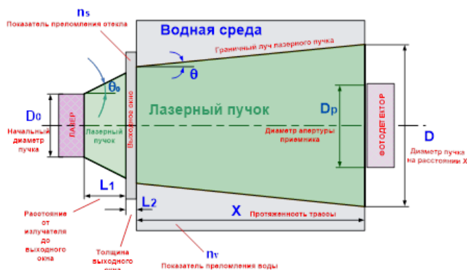
Рис. 1. Физическая модель распространения лазерного пучка в водной среде
