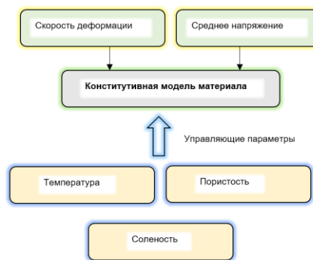
Рис. 1. Учет факторов, влияющих на механические характеристики льда, в рамках модели материала
