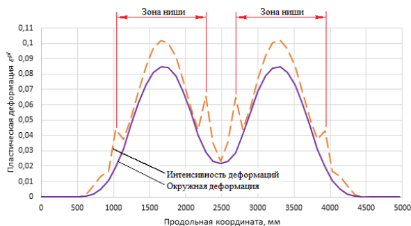
Рис. 4. Распределение интенсивности пластических деформаций и главной (окружной) пластической деформации по наружной поверхности сваи (вдоль деформированного положения образующей этой поверхности) для исходной конструкции РС
