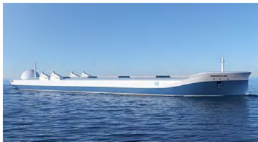
Рис. 13. Проект беспилотного грузового судна с дистанционным управлением
