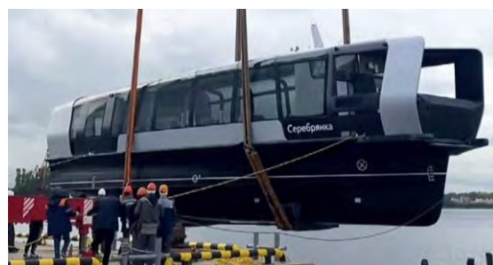
Рис. 3. Прогулочно-экскурсионное судно-катамаран «Серебрянка» - первое российское судно-прототип, работающее на водороде
