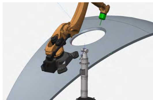
Рис. 6. Размещение обрабатывающего центра на объекте
