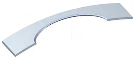
Рис. 3. Поверхность разделки под сварку, построенная по традиционной технологии
