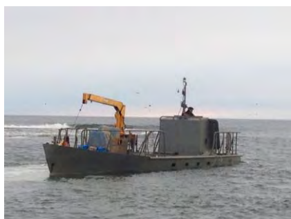
Рис. 1. Бот для транспортировки рыбы (проект 888): а – погрузка рыбы из невода; б – бот на ходу
