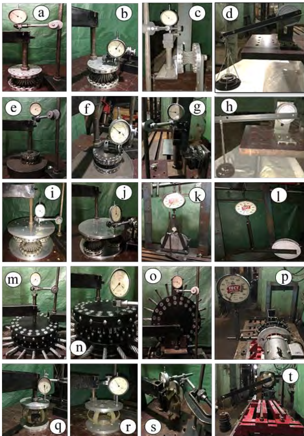
Рис. 2. Композитная (q - t) и канатные (а - р) муфты MAMSAR со средствами статических испытаний на осевой сдвиг, излом, радиальное смещение и кручение
