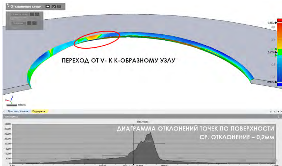
Рис. 10. Погрешность сравнения двух поверхностей. На диаграмме вертикальная ось показывает количество точек сравнения по поверхности
