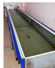
Рис. 14. Модель бота проекта 333 (а) и опытовый бассейн (б)
