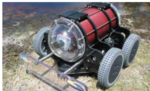
Рис. 11. Робот HullBUG для очистки корпуса судна
