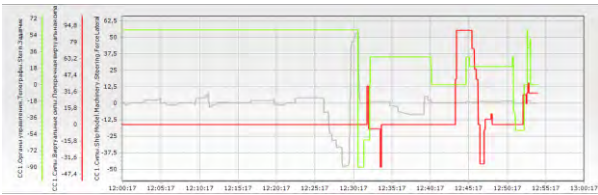
Рис.9 Силы от ВРК судна и АПУ, действующие на корпус судна.
