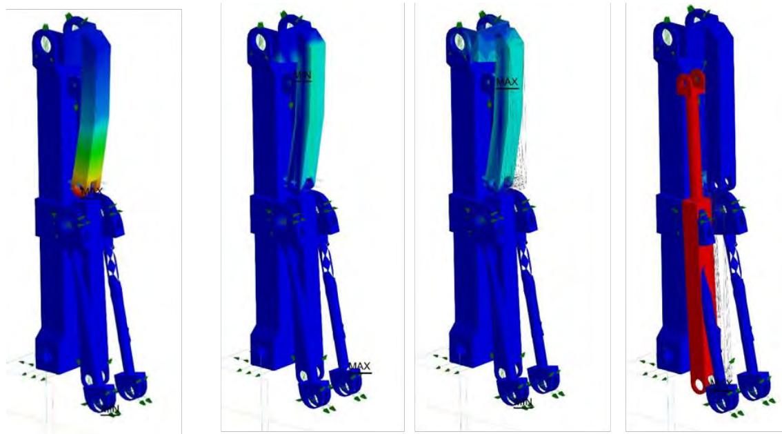
Рис. 8. Этап эксперимента на устойчивость ЭМШУ в APM FEM
