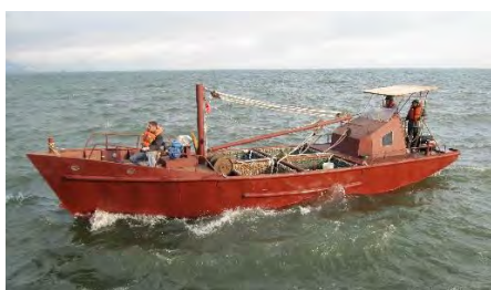
Рис. 3. Лодка-прототип на ходу при осушенных грузовых отсеках
