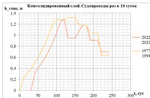
Рис. 14 – Изменение толщины консолидированного слоя по температурным данным 1977-1994 гг. и 2022/2023 г. с частотой прохода раз в 10 суток
