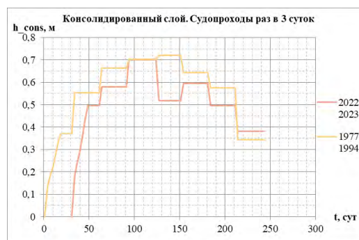
Рис. 12– Изменение толщины консолидированного слоя по температурным данным 1977-1994 гг. и 2022/2023 г. с частотой прохода раз в 3 суток
