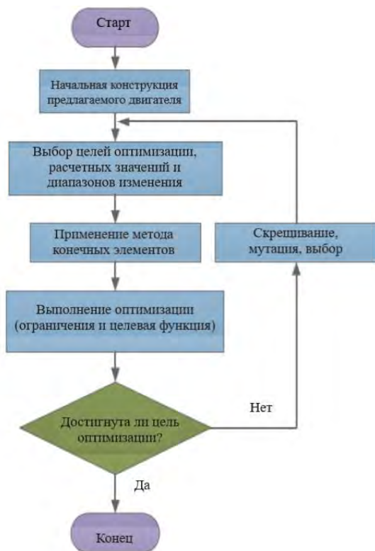
Рис. 2 Блок-схема использования генетического алгоритма для оптимизации дизель-электрической судовой установки
