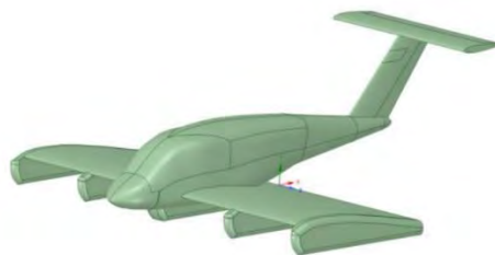
Рис. 1 – Аэродинамическая компоновка экраноплана самолетной схемы
