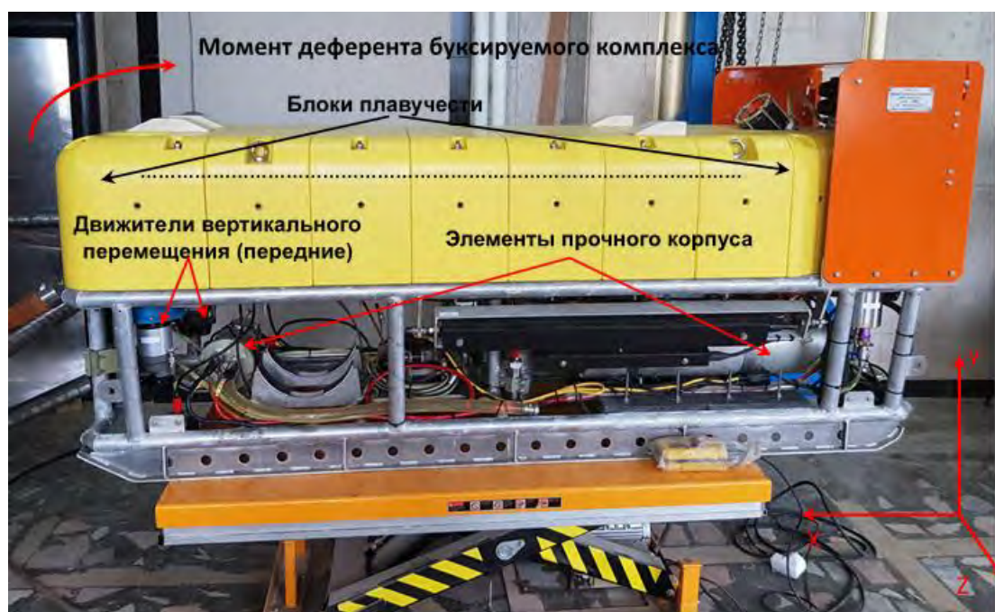
Рис. 1. Носитель нейтральной плавучести буксируемого геофизического комплекса УМБК
