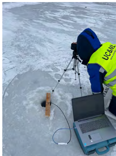
Рис. 3 - Расположение ведущего модема на льду в ходе проведения эксперимента
