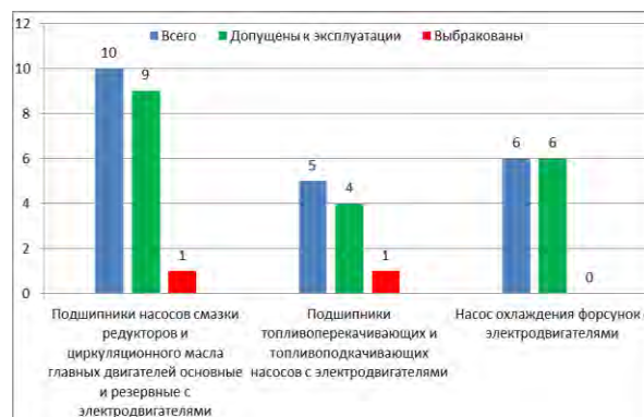
Рис.6. Результаты контроля вспомогательных механизмов ледокола
