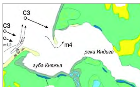
Рис 4 Предлагаемый комплекс оградительных сооружений типа «мол – волнолом»
