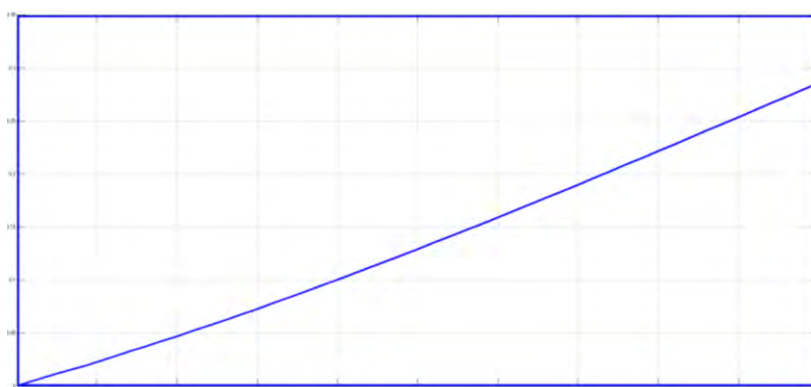
Рис. 5 – график изменения скорости движения ТНПА при заданных параметрах скорости и настройках регулятора, как показано на рисунке 3 ( K_p = 50 )
