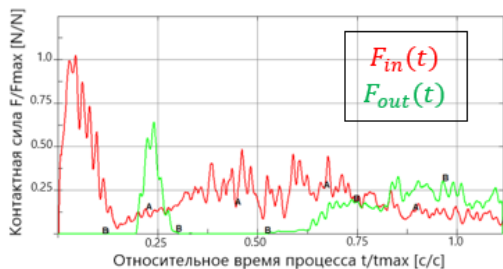
Рис. 12. Характерные процессы изменения контактных сил F_{in}(t), F_{out}(t) между образцом и стержнями установки, численный расчет
