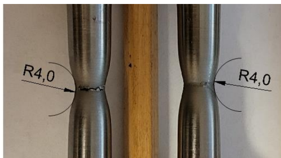
Рис. 7. Результаты определения радиуса кривизны контура шейки
