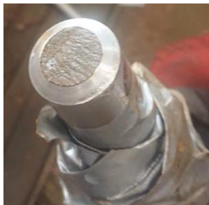
Рис. 17. Разрушенная шпилька устройства аварийного открытия люка после испытаний
