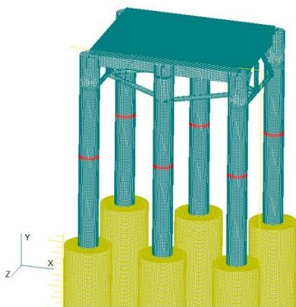
Рис. 2. Пространственная (3D) конечно-элементная модель безраскосной конструкции стационарной платформы как системы «сооружение – свайный фундамент – грунтовое основание»
