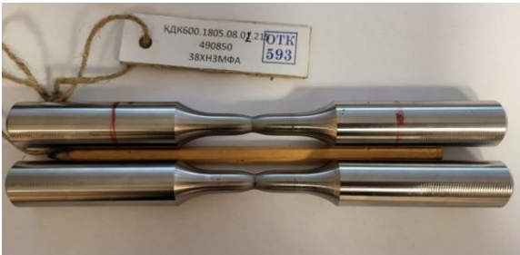
Рис. 6. Образцы 1 и 2 после испытаний
