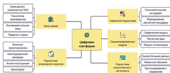
Рис. 9. Структура цифровой платформы, обеспечивающей управление свойствами объекта на всех этапах жизненного цикла и накопление и обобщение информационных потоков
