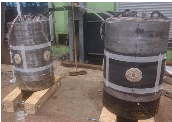
Рис. 14. Модели испытательного объекта перед проведением динамических испытаний в модели Капсулы
