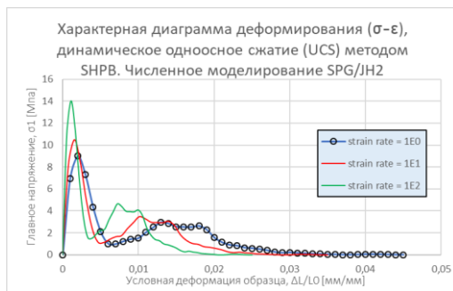
Рис. 13. Характерная динамическая диаграмма деформирования (осевые \sigma - \epsilon ) по результатам численного моделирования методом SPG
