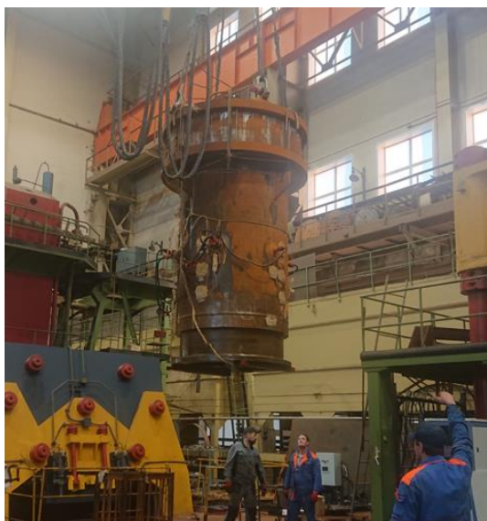
Рис. 15. Выгрузка модели Капсулы из ДК-1000 (МИО находится внутри модели)
