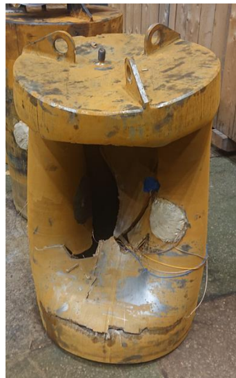
Рис. 16. Вид разрушенной МИО №3 после испытаний
