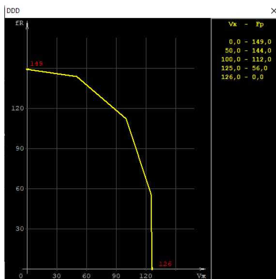
Рис. 7. График зависимости значений первой собственной частоты от скорости движения жидкости
