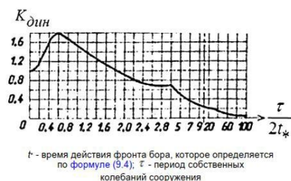
Рис. 4. График коэффициентов динамичности для прибрежных сооружений (справа)
