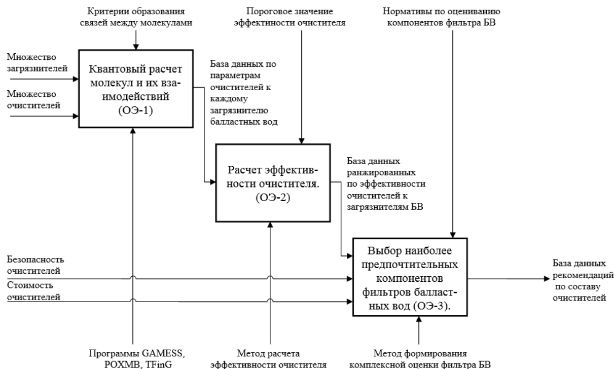
Рис. 2. Детализированная IDEF0 диаграмма процесса выбора фильтра
