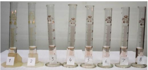
Рис. 11 – Массовая концентрация общего железа без эжекции воздуха
