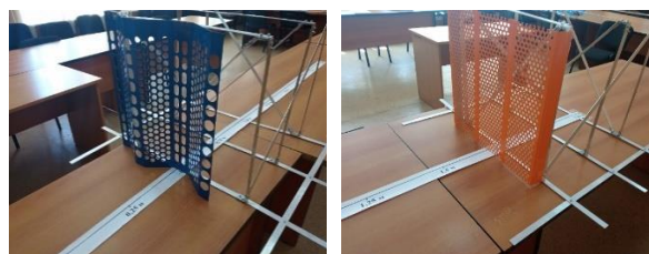
Рис. 5. Установка жестких экранов в панелях рамочного устройства.
