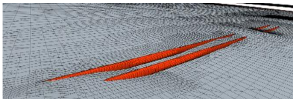
Рис. 3. Учет геометрии водоводов, расположенных выше дна реки (провисающие участки)
