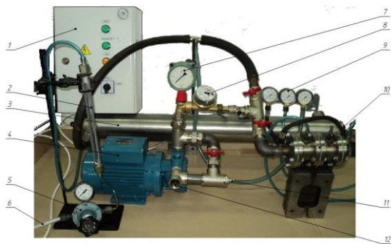
Рис.2– Внешний вид экспериментального стенда (емкости и часть трубопроводов демонтированы)
