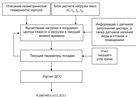
Рис. 6. Блок-схема построения ДСО.
